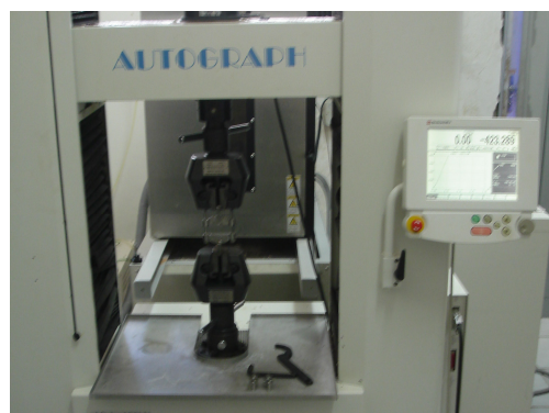
FIGURA 29. Máquina Universal de Ensaios (AUTOGRAPH, SHIMADZU).
