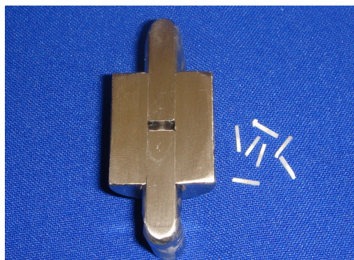
FIGURA 27. Grip do dispositivo de microtração, para posicionamento dos espécimes.
