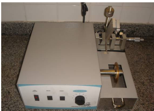
FIGURA 22. Cortadeira metalográfica de precisão
