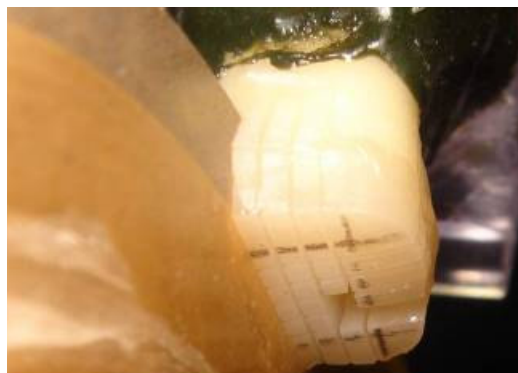
FIGURA23. Seccionamento das amostras com o disco diamantado de alta concentração.
