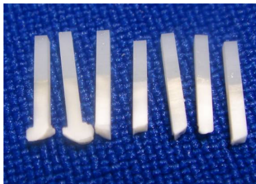
FIGURA 25. Espécimes em forma de palitos contendo a área de teste de aproximadamente 1,0\text{mm}^2 .
