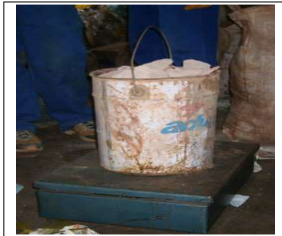
FIGURA 4.34 – Pesagem do material separado por tipo para a caracterização do RCD
