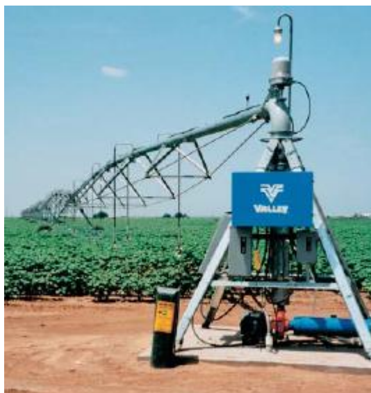
Figura 2.7: Base do sistema de pivô central.
