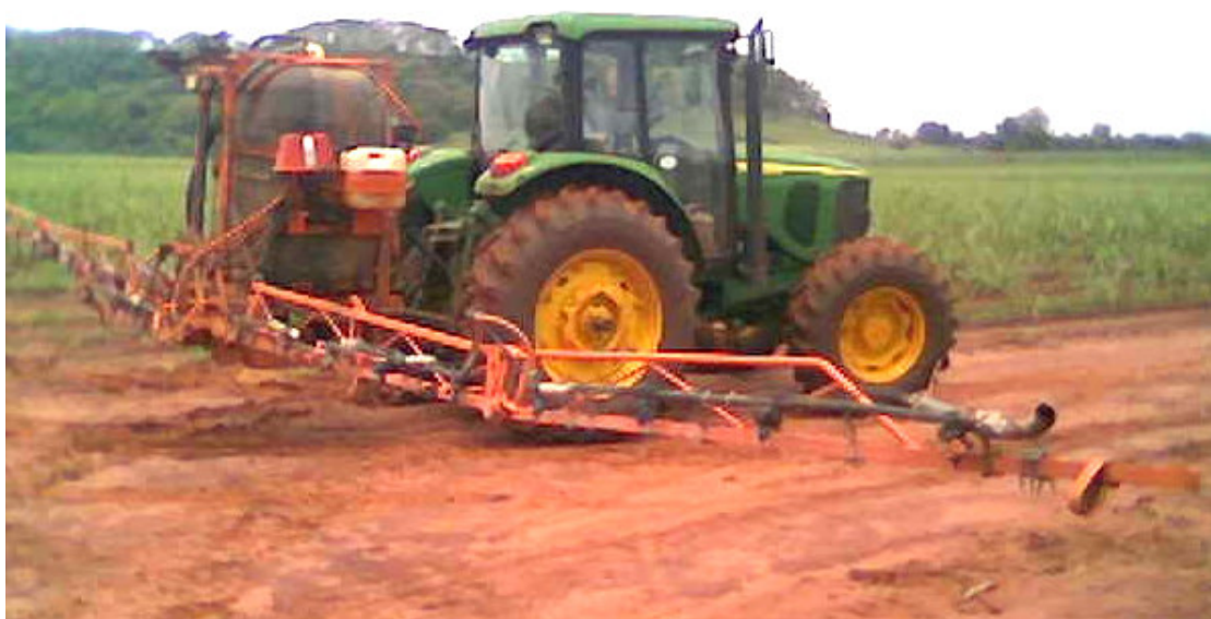
Figura 5. Trator John Deere com cabina original, equipado com pulverizador de Barra Traseira, modelo Falcon 800.
