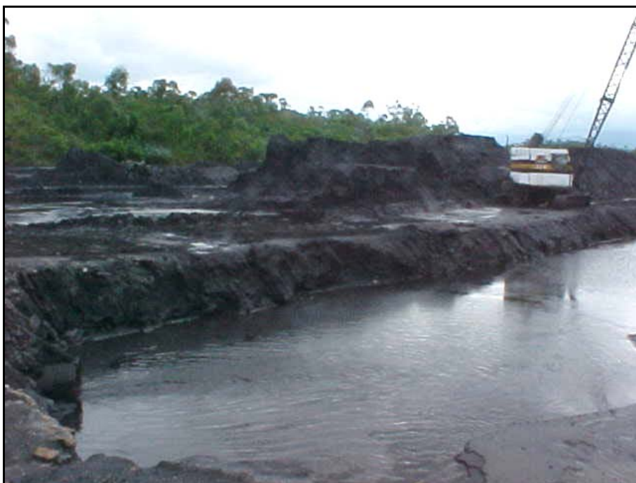
Figura 6 – Detalhe da bacia de finos. Ao fundo draga removendo finos para as margens. Fonte: Jairo José Zocche e Micheli de Freitas.
