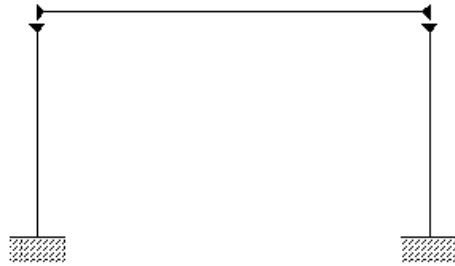
Figura 2.2 - Sistema aperticado com pilar engastado na fundação e viga engastada nos pilares.
