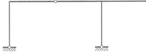
Figura 2.12 - Pórticos triarticulados para galpões.
