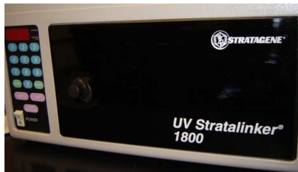
FIGURA 7 - UV Stratalinker ® : fixação do DNA das amostras na membrana.
