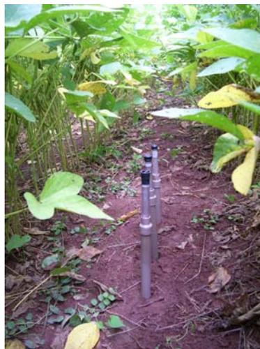
**Figura 3:** Tensiômetros instalados no ensaio sobre um Nitossolo Vermelho, município de Mococa, SP.
