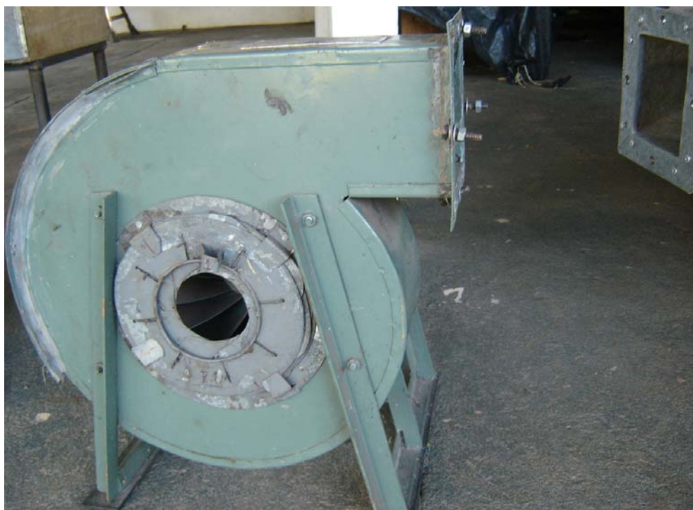
Figura 08. Ventilador centrífugo de pás retas, marca Blasi, modelo VC 30
