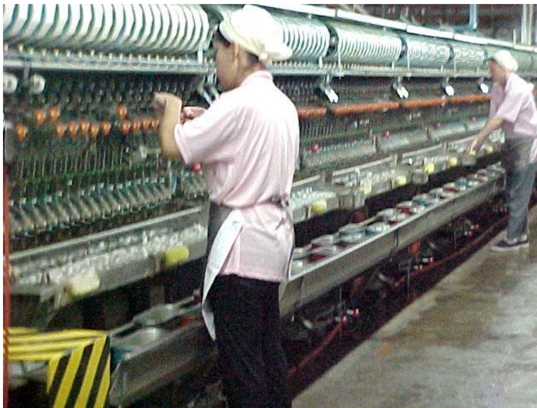
Figura 3. Detalhe da fiandeira utilizada no processo de desenrolamento
