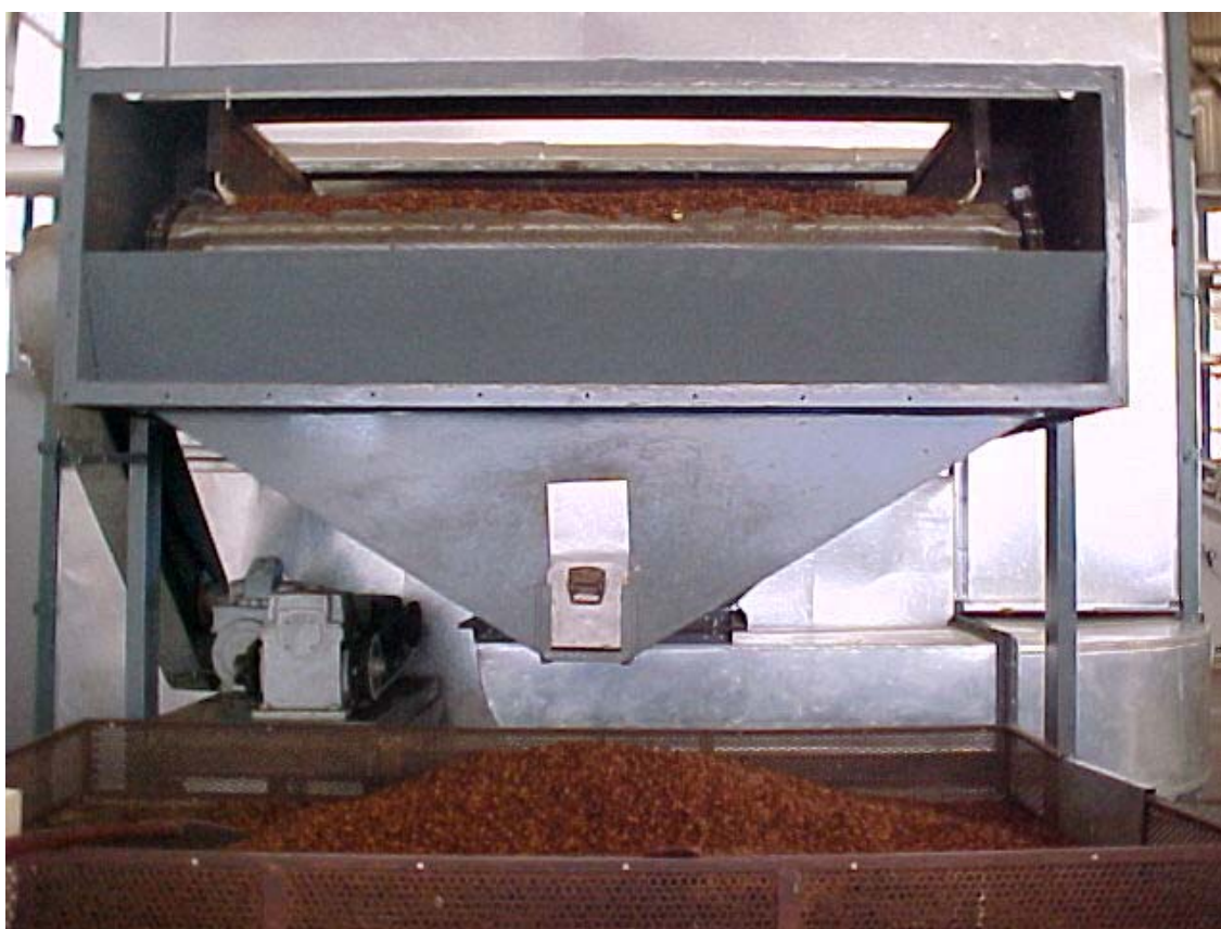
Figura 4. Detalhe da cardadeira utilizada para destrinchar os casulos que não conseguiram comportar o processo da escupinadeira e da fiandeira
