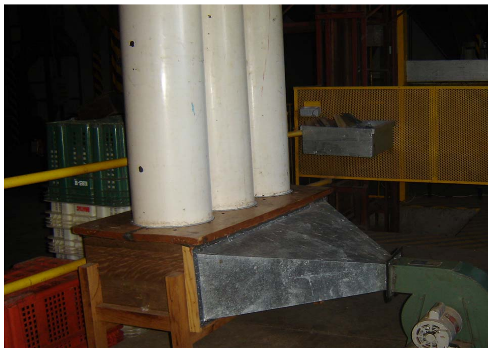
Figura 07. Esquema do protótipo utilizado na secagem em baixa temperatura, com detalhe das colunas de PVC (câmara de secagem).
