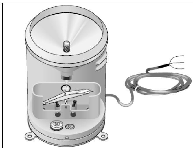
Figura 9. Pluvimetro TB4-L utilizado para a avaliao da precipitao pluviomtrica no local.
