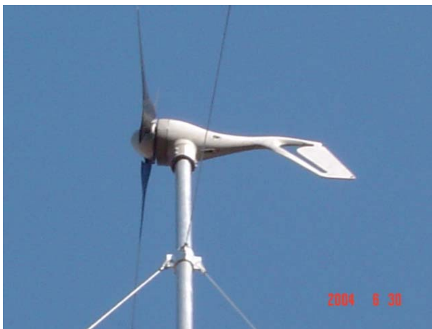
Figura 10. Aerogerador AIR-X com potência nominal de 400W, instalado no sistema híbrido.
