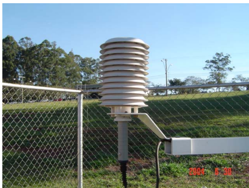
Figura 8. Sonda termo higrômetro HMP45C utilizada para determinar a temperatura ambiente do local.
