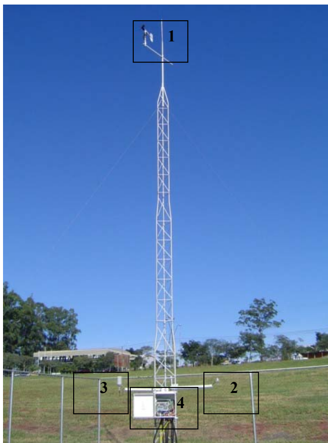
Figura 5. Torre utilizada para a instalação dos equipamentos de medição meteorológica e aquisição de dados. 1 – Anemômetro; 2 – Piranômetro; 3 - Termo higrômetro; 4 – Datalogger CR23-X.
