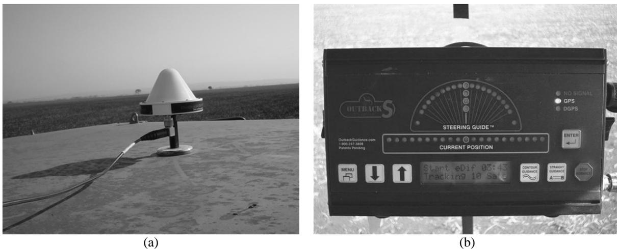
Figura 3. Receptor GPS SatLoc (a) e barra de luz modelo Outback S (b).
