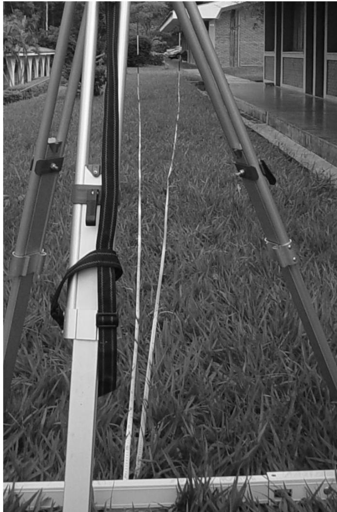
Figura 13. Visualização do erro de  $3^\circ$  cometido na mensuração dos desvios pela não perpendicularidade da trena em uma distância de 20 m.
