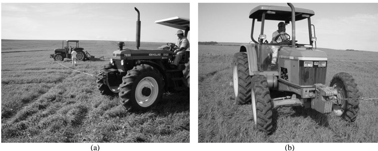
Figura 8. Sistema de marcação de rastro por cabo de aço (a) e trator utilizado como guia (b).
