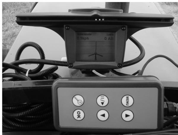
Figura 6. Barra de luz Trimble modelo Ez-Guide Plus.
