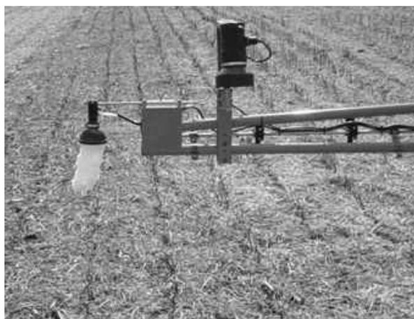
Figura 7. Marcador de linha por espuma MasterMark instalado no pulverizador autopropelido.
