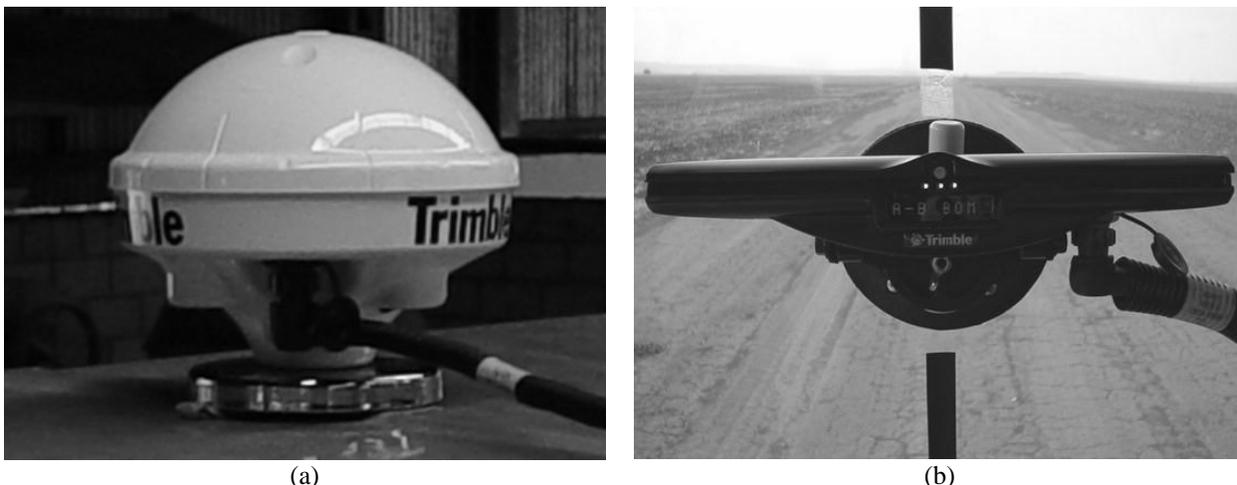
Figura 2. Receptor GPS Trimble (a) e barra de luz Trimble Ez-Guide (b) instalados no pulverizador autopropelido.
