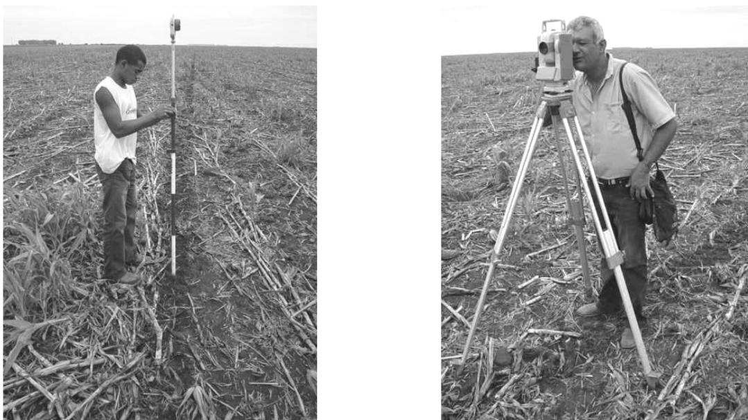
Figura 14. Equipamento topográfico utilizado no Experimento 2 para mensuração dos desvios perpendiculares ao alinhamento de referência.
