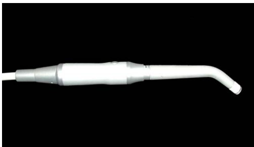
FIGURA 3 – Protótipo de LED desenvolvido pelo CEPOF.
