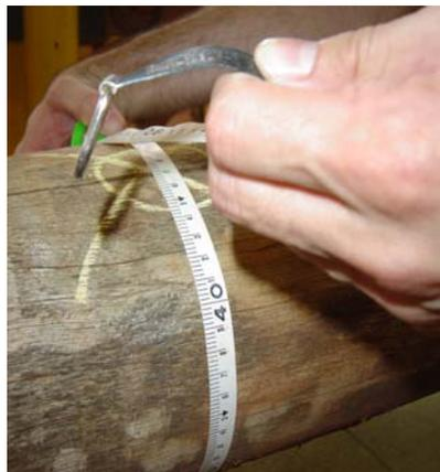
Figura 25 – Comprimento da circunferência do elemento roliço medido em  $L/2$ .
