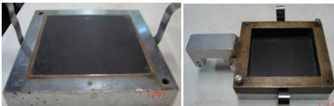
Figura 4.36 - Interface de aço ensaiada instalada na meia-caixa inferior
