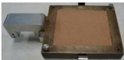
Figura 4.37 - Caixa com a amostra pronta para o ensaio
