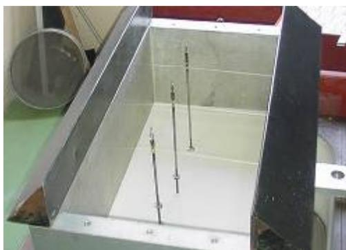
Figura 4.28 - Fixação das estacas no container com linhas de nylon
