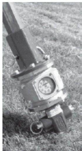
Figura 2.14 – Torquímetro (A. B. Chance Co., 2004)
