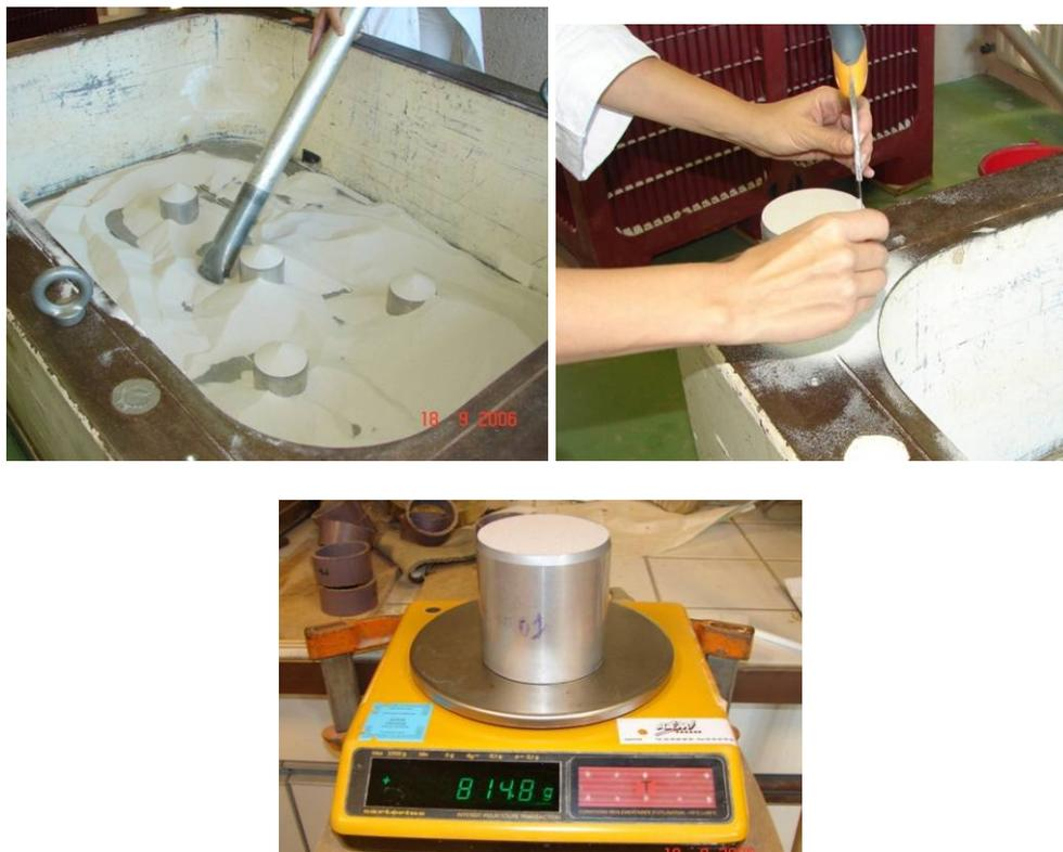
Figura 4.15 – Controle do peso específico do maciço após o ensaio em centrífuga
