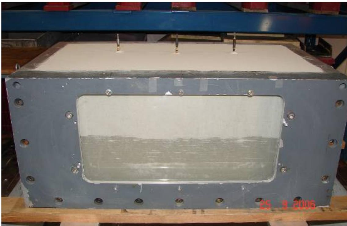
Figura 4.31 – Saturação do maciço de areia por capilaridade após ensaio de tração nas estacas
