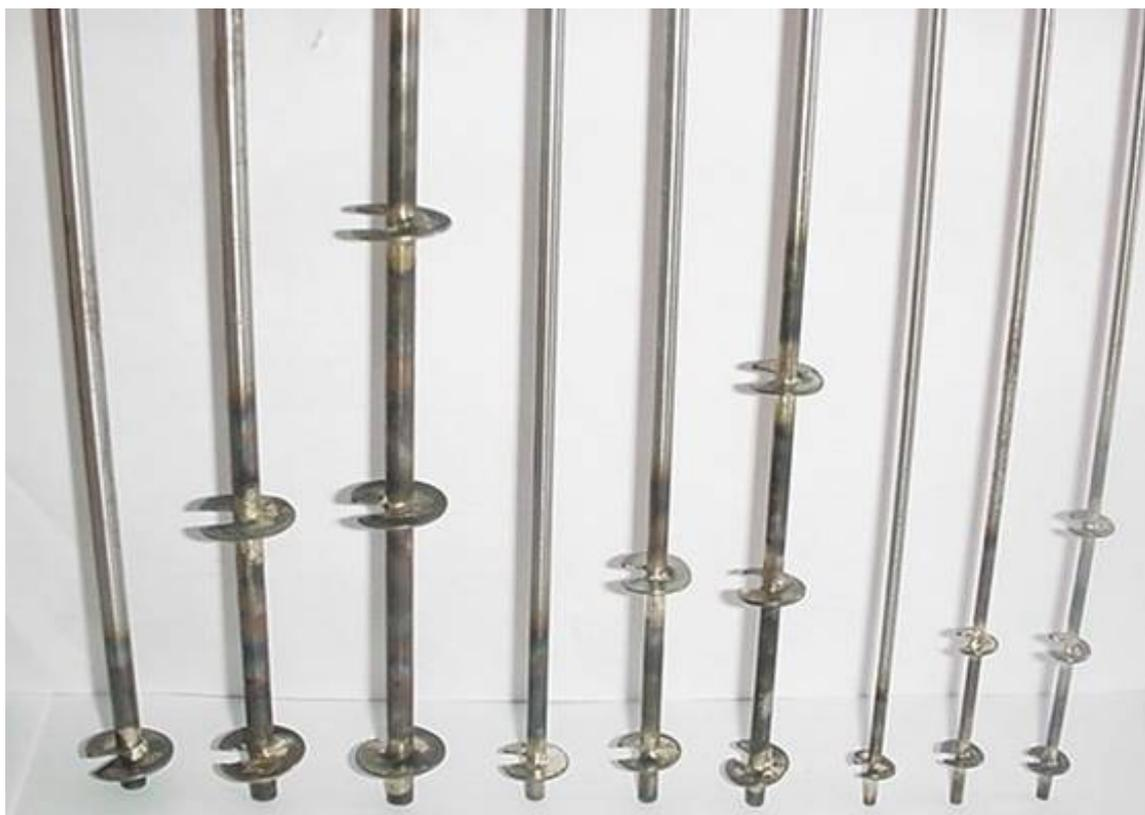
Figura 4.18 - Fotografia dos modelos de estacas metálicas helicoidais (Grupo I)
