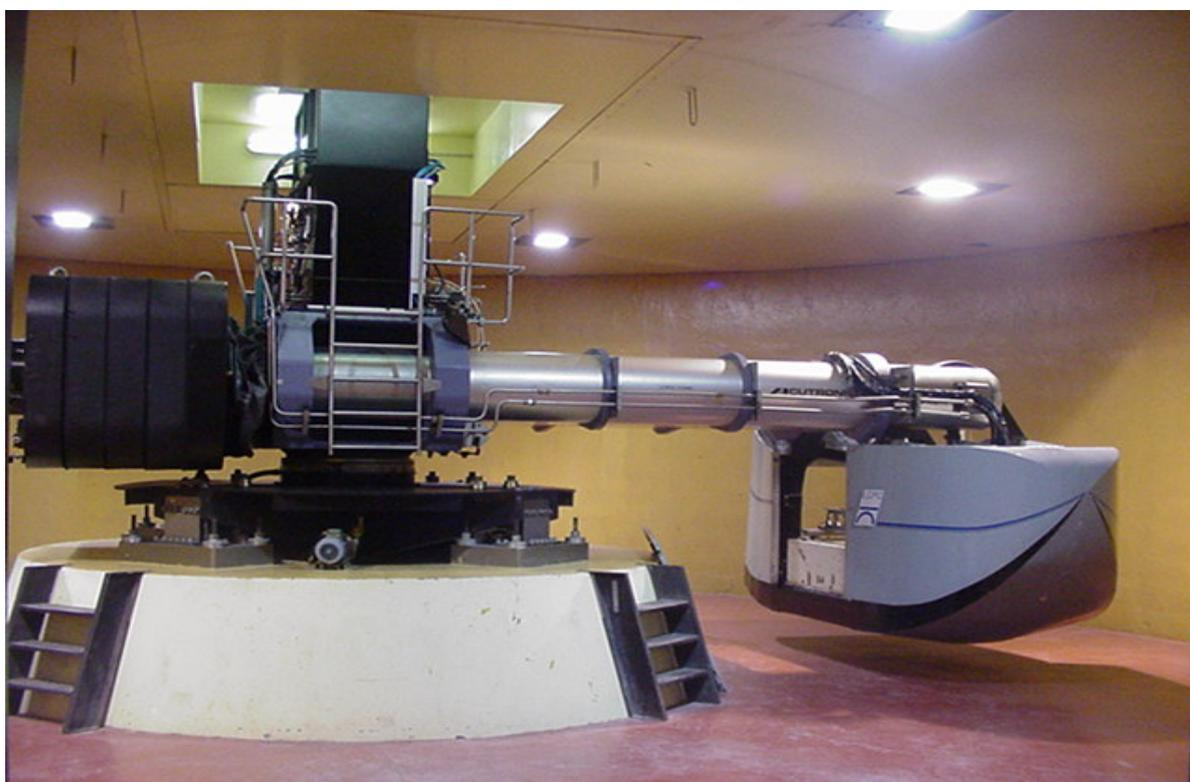
Figura 4.17 - Centrífuga do LCPC
