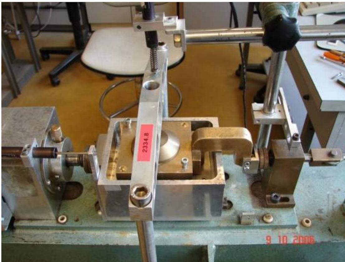
Figura 4.35- Ensaio de cisalhamento na interface
