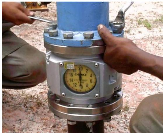
Figura 4.5 - Torquímetro utilizado em Contagem
