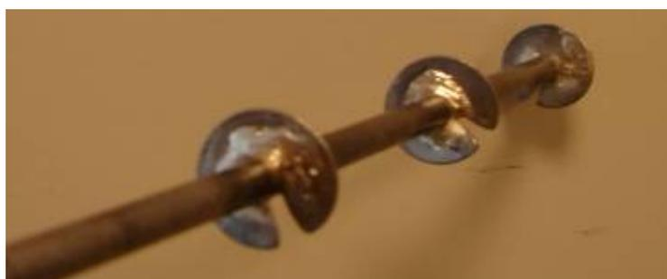
Figura 4.32 - Fotografia das superfícies das hélices da estaca modelo N°9
