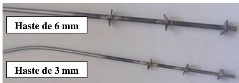
Figura 4.25 - Estacas danificadas após a penetração por rotação de 280 mm dentro do maciço de areia ( $D_r = 85\%$ ) a 22 g
