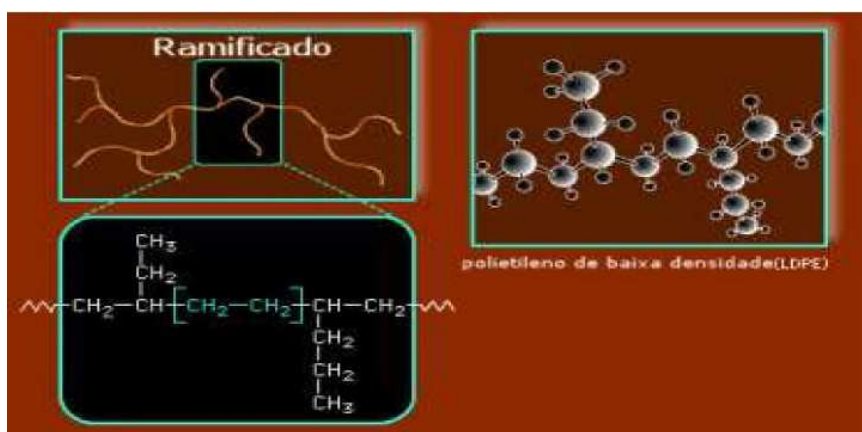
Figura 7 - Cadeia polimérica ramificada de Polietileno de baixa densidade [Motta, 2002].
