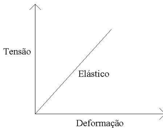
Figura 25 – Modelo linear-elástico do material [CosmosWorks, 2005].
