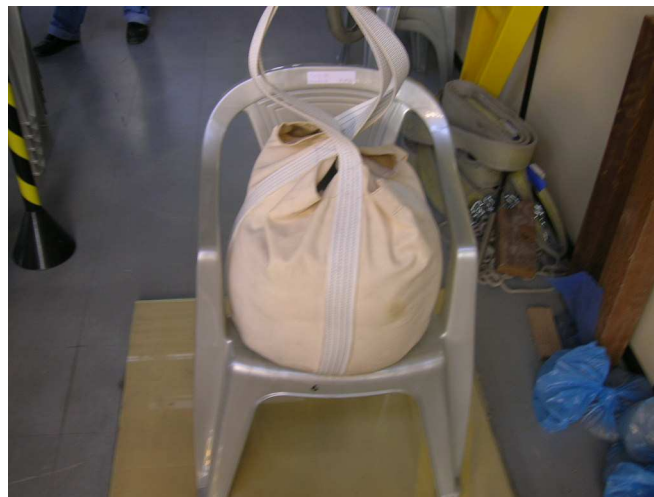
Figura 79 – Ensaio estático da cadeira plástica tipo monobloco.
