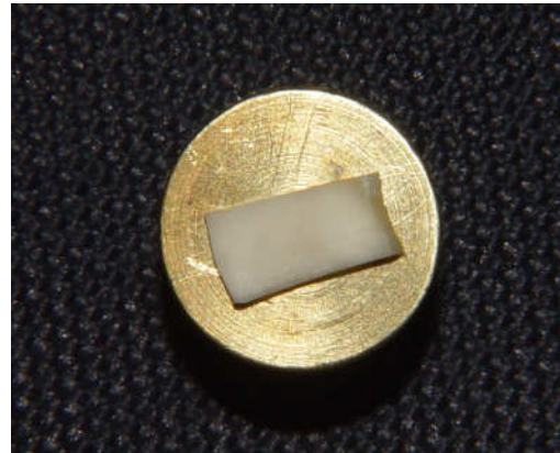
FIGURA 19 – Amostra colada no suporte metálico.
