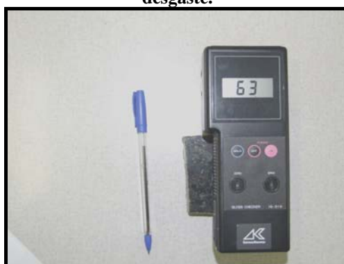
Figura 4.127 – Procedimento de medida do brilho nas amostras estudadas.
