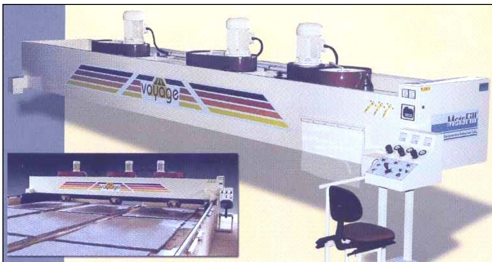
Figura 2.23 – Exemplo de politriz de ponte móvel de três cabeçotes (CETEMAG, 2003).
