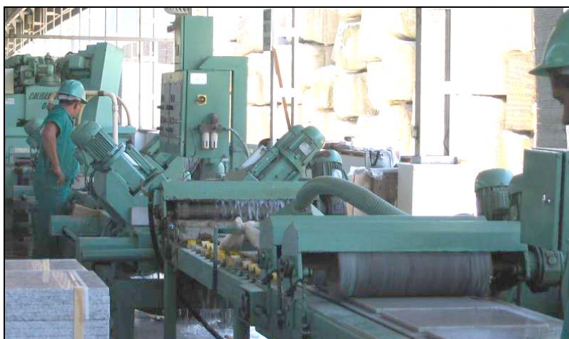
Figura 2.20 – Linha de produção em ladrilhos: da calibração ao polimento (CETEMAG, 2003).
