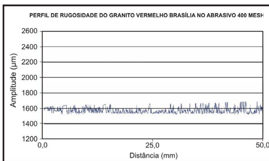
Figura 4.66 – Rugosidade do granito Vermelho Brasília na sexta etapa de desgaste.
