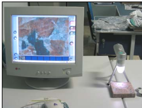
Figura 3.21 – Conjunto lupa digital e imagem captada para análise qualitativa das superfícies das rochas submetidas ao polimento industrial ( Scalar W50 ).
