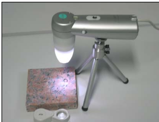
Figura 3.22 – Captação da imagem da superfície da amostra de rocha ( Scalar W50 ).
