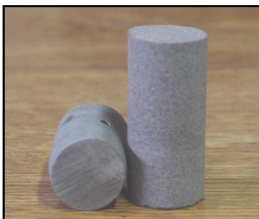
Figura 4.139 – Amostra retirada do rebolo abrasivo para o ensaio SPR (diâmetro = 2 cm).
