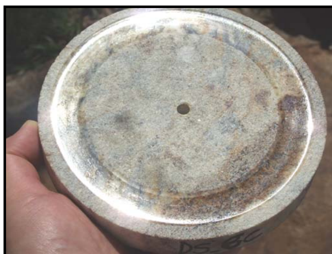
Figura 4.166 – Detalhe do corpo-de-prova após ensaio no SPR.
