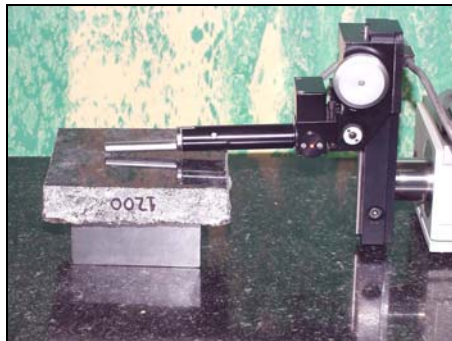
Figura 3.20 – Detalhe do procedimento da determinação da rugosidade das amostras de rocha ( Talysurf ).
