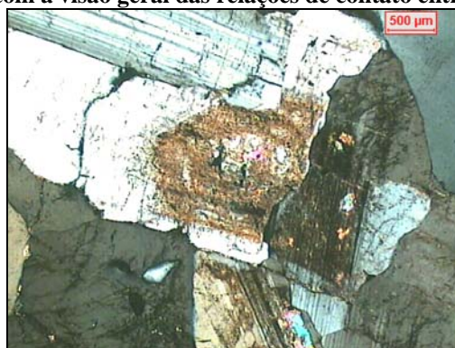
Figura 3.3 – Fotomicrografia mostrando plagioclásio pigmentado por óxidos e hidróxidos de ferro, evidenciando argilomineralização (nicóis cruzados).
