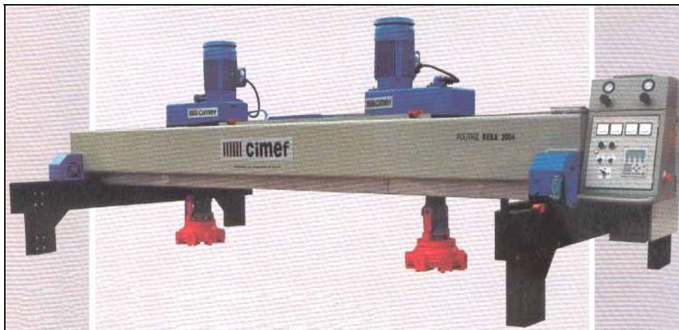
Figura 2.22 – Exemplo de politriz de ponte móvel de dois cabeçotes (CETEMAG, 2003).
