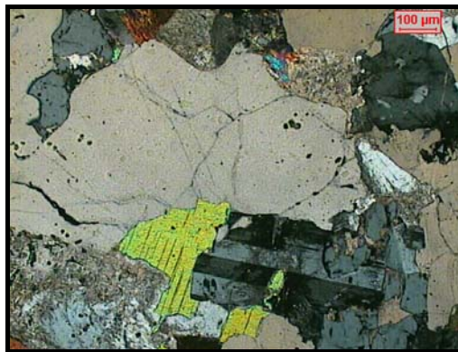
Figura 3.8 – Fotomicrografia de cristais de feldspato plagioclásio com diferentes graus de saussuritização (nicóis cruzados).
