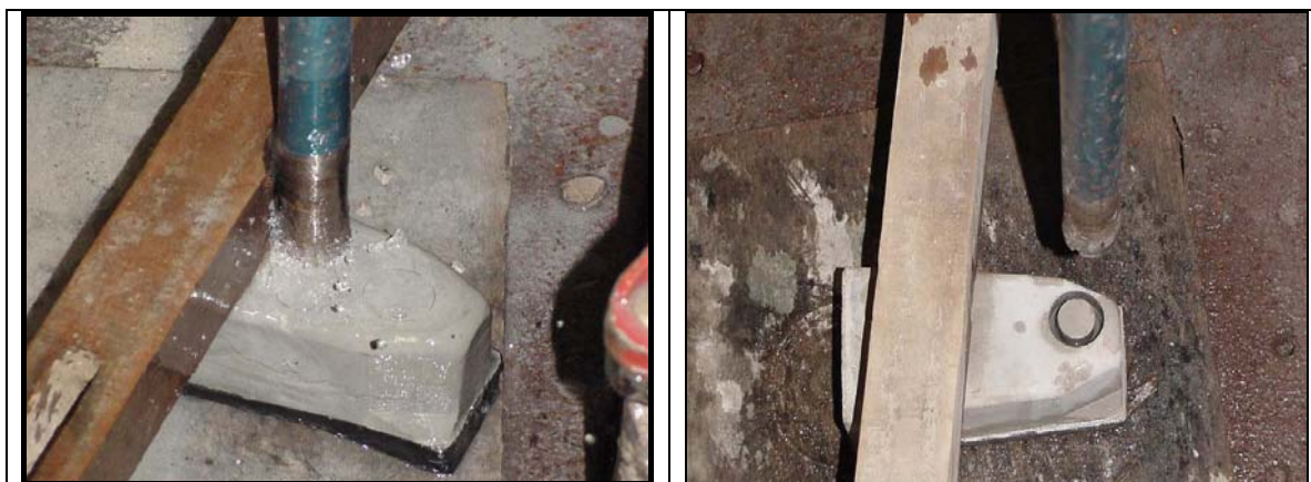
Figura 4.138 – Procedimentos de amostragem do corpo-de-prova de abrasivo utilizado no ensaio SPR.
