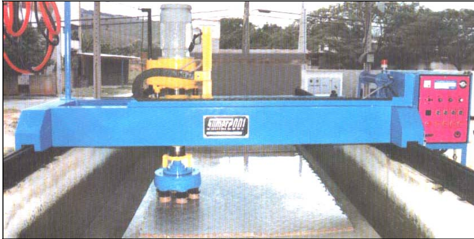
Figura 2.21 – Exemplo de politriz de ponte móvel de um cabeçote (CETEMAG, 2003).
