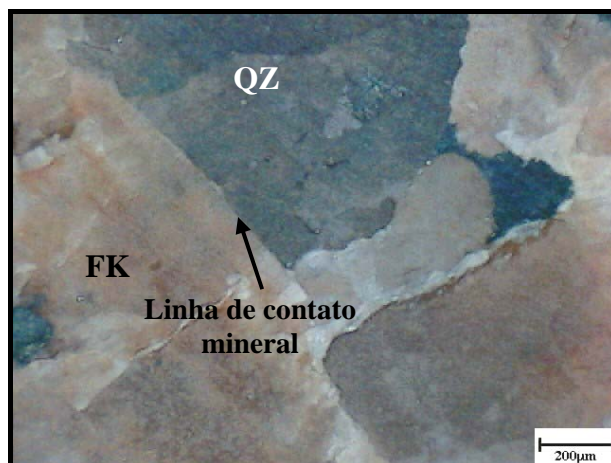
Figura 4.67 – Amostra do granito Vermelho Brasília submetido a solicitações de desgaste com abrasivo 400 mesh. Notar o bom fechamento entre os cristais de quartzo e feldspato potássico.
