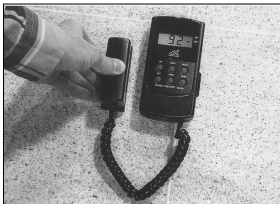
Figura 2.5 – Medidor de brilho ( glossmeter ) em ladrilho de granito (CETEMAG, 2003).
