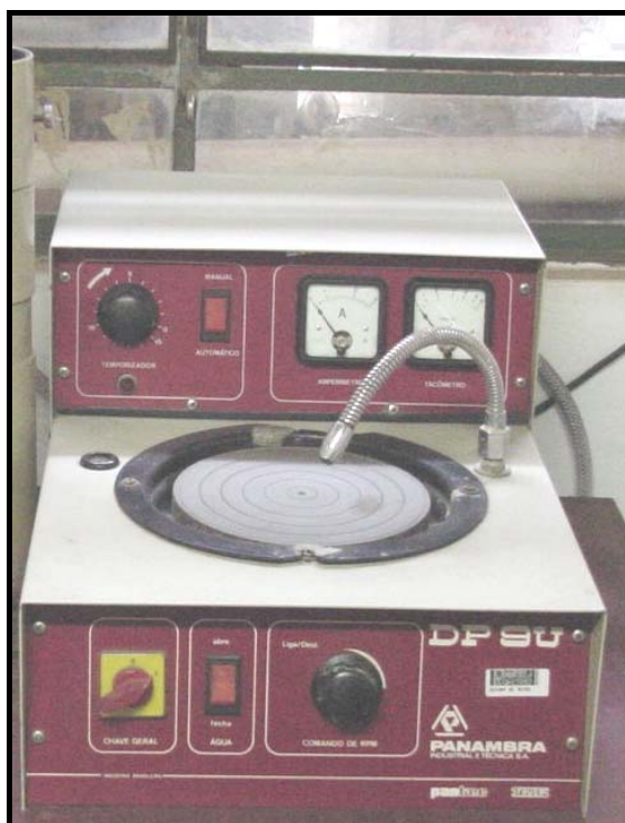
Figura 4.132 – Politriz para preparação de lâmina delgada para rochas utilizada como base para o desenvolvimento do Simulador de Polimento de Rocha (SPR).
