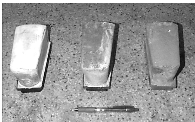
Figura 2.11 – Rebolos abrasivos magnesianos utilizados no polimento de rochas ornamentais (Foto do Autor).
