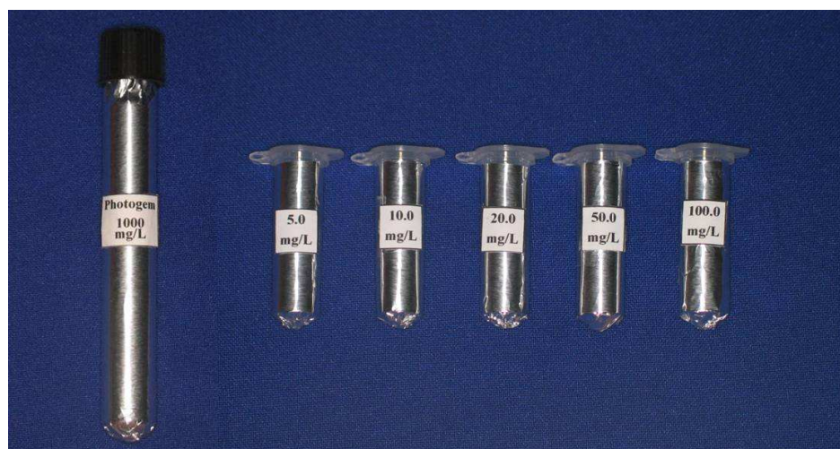
FIGURA 3 – Tubo de ensaio contendo a solução estoque de Photogem ® (1000 mg/L), juntamente com as cinco diluições preparadas nos microtubos.
