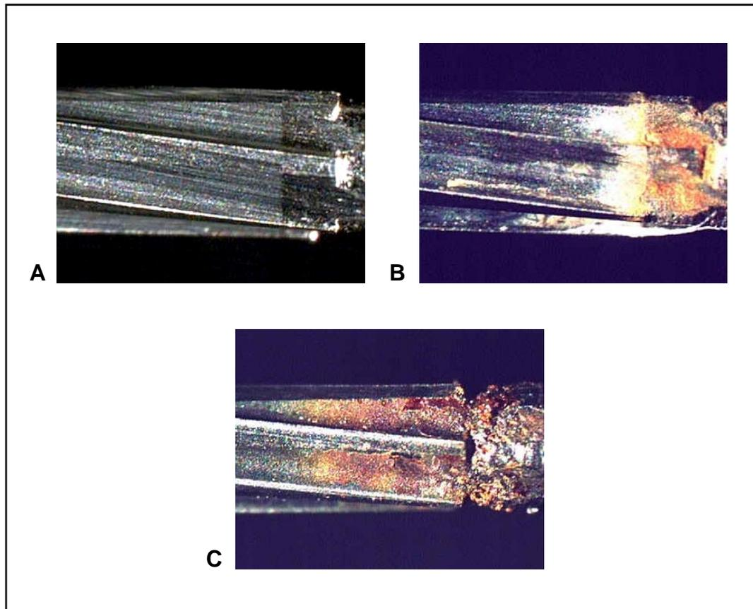
FIGURA 9 - Fotomicrografias, em lupa estereoscópica (32X), da interface ponta ativa/ haste metálica de uma fresa *carbide* do grupo E5 (glutaraldeído), A- antes do uso; B- após o primeiro ciclo de esterilização e C- após o sexto ciclo de esterilização.
