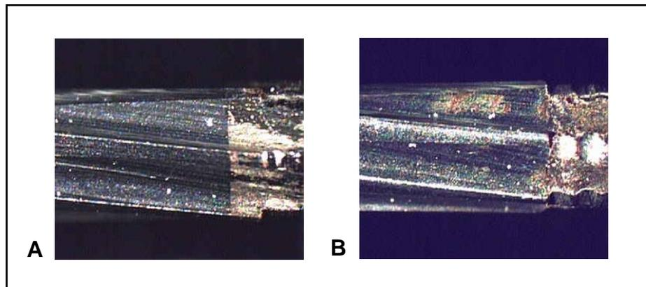
FIGURA 8 - Fotomicrografias, em lupa estereoscópica (32X), da interface ponta ativa/ haste metálica de uma fresa *carbide* do grupo E4 (microondas), A- antes do uso e B- após 12 ciclos de esterilização.
