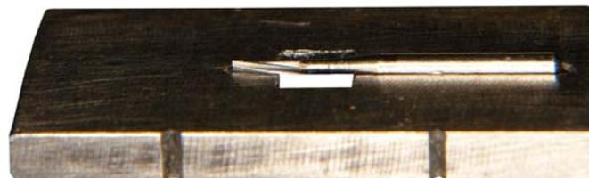
FIGURA 4 - Fresa *carbide* posicionada no suporte metálico.
