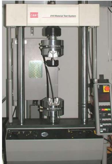
FIGURA 2 - Máquina de Ensaio Mecânico MTS.
