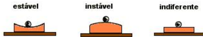
Figura 2.3: Um forma de se observar os três tipos de equilíbrio: um corpo esférico em diferentes tipos de superfícies.
