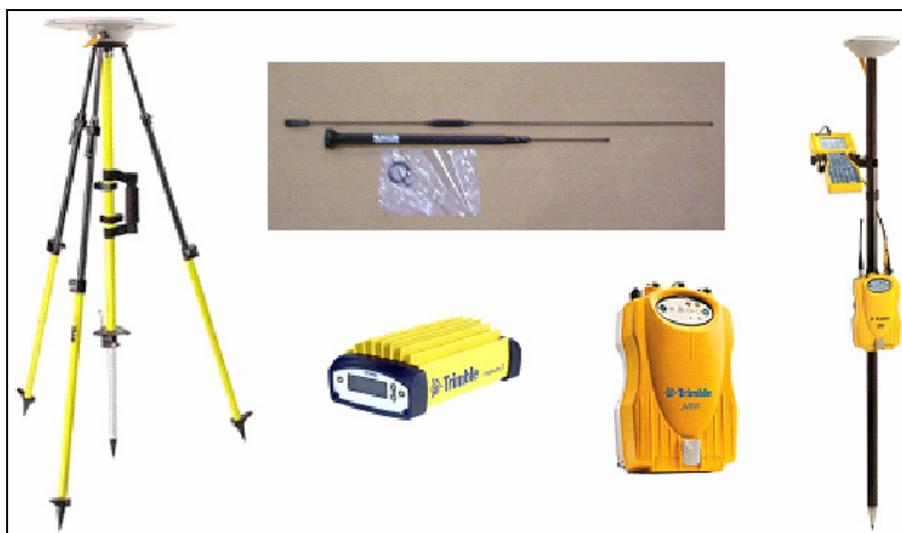
Figura 11 – Receptor GPS R7/R8 RTK da TRIMBLE
