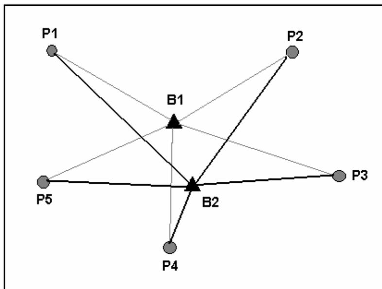
Figura 2 – Irradiação a partir de dois vértices de apoio básico
