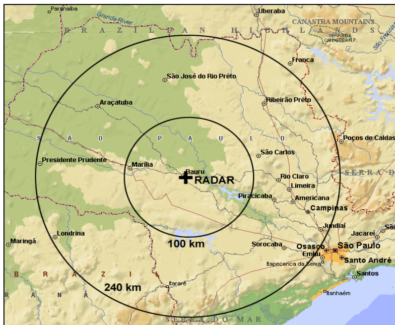
Figura 2. Área selecionada para o estudo, raio de alcance de 240 km a partir do radar meteorológico Doppler de Bauru.
