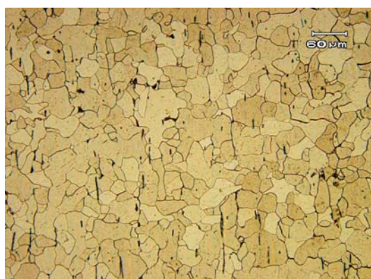
Figura (5.20) – Micrografia mostrando a microestrutura ferrítica do material.
