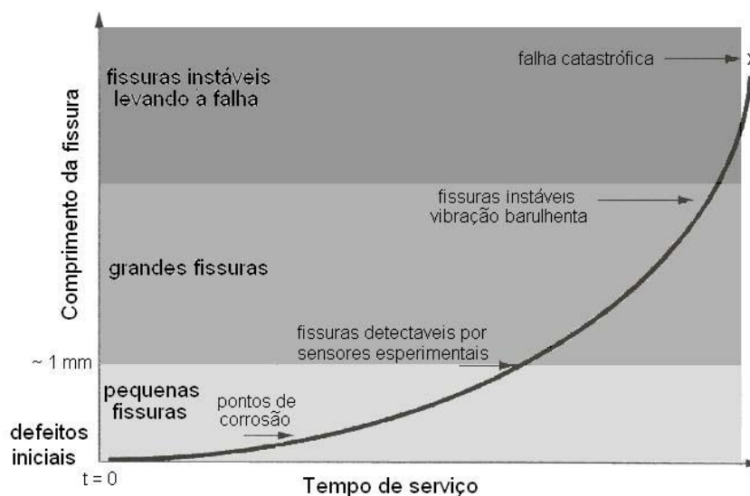
Figura (2.11) – Ilustração esquemática dos quatro estágios de falha em termos do comprimento da fissura versus tempo de serviço.
