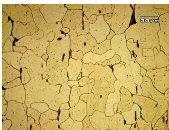
Figura (5.21) - Micrografia mostrando a microestrutura ferrítica do material, em maior aumento.
