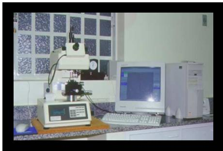
1. Microdurômetro Shimadzu Micro Hardness Tester HMV-2.000 (Shimadzu Corporation - Kyoto-Japan), com penetrador tipo Knoop, acoplado ao Software para análise de imagem CAMS-WIN (NewAge Industries, USA).
