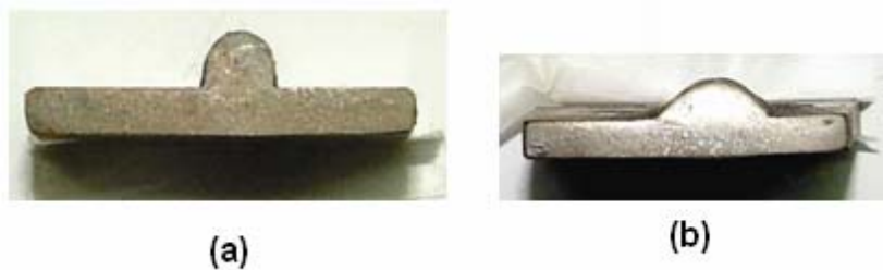
Figura 4.16 – Perfil do cordão de solda com proteção gasosa C25: (a) tensão 19V IND 2 e (b) tensão 23V, IND. 5.
