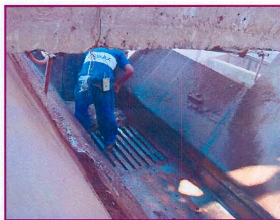
FIGURA 33 – Usina C – Operador do britador desobstruindo a caçamba do equipamento.
