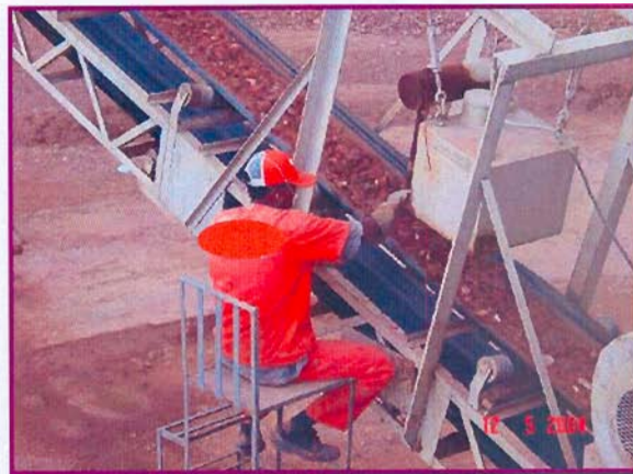
FIGURA 31 – Usina A – Triagem na esteira transportadora
