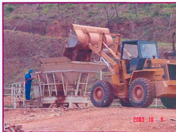
FIGURA 29 – Usina A – Operador da pá carregadora depositando o entulho na caçamba do britador
