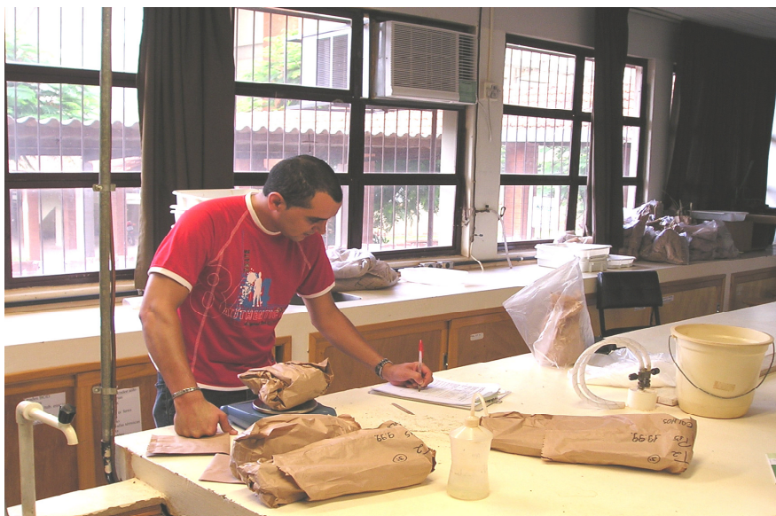
Figura 13 – Pesagem das amostras secas em balança digital ( \pm 0,1 g), para avaliação do peso constante na determinação das relações alométricas em L. leucocephala (Lam.) De WIT, em Marechal Cândido Rondon/PR, Unioeste, 2006.
