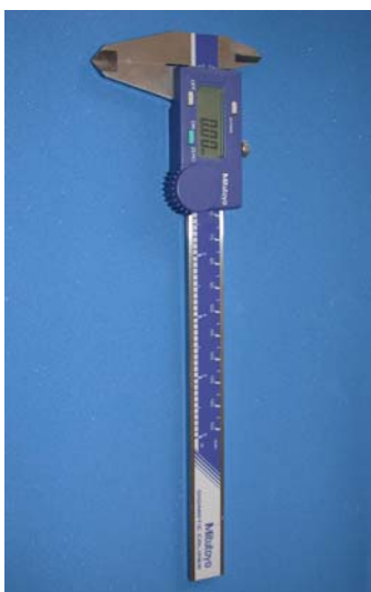
Figuras 13.1 e 13.2 - Utilização do paquímetro universal para medição da área de secção transversal dos espécimes
