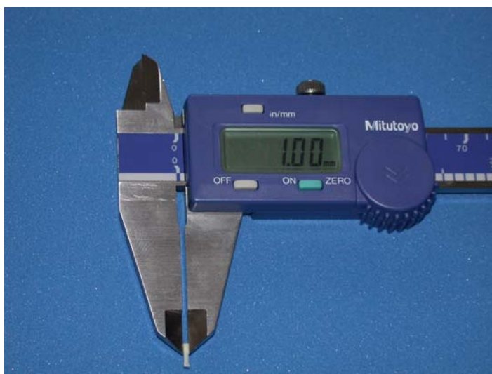
Figuras 13.1 e 13.2 - Utilização do paquímetro universal para medição da área de secção transversal dos espécimes
