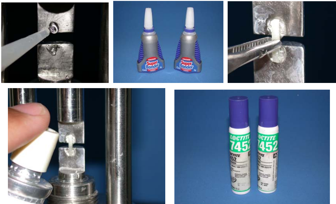
Figuras 11.1, 11.2, 11.3, 11.4 e 11.5 - Adaptação à uma máquina de ensaios universal modelo. Colagem do espécime pelas suas extremidades perpendicularmente a interface adesiva com o adesivo à base de cianocrilato e seu respectivo acelerador de presa (Superbond, Loctite, USA)
