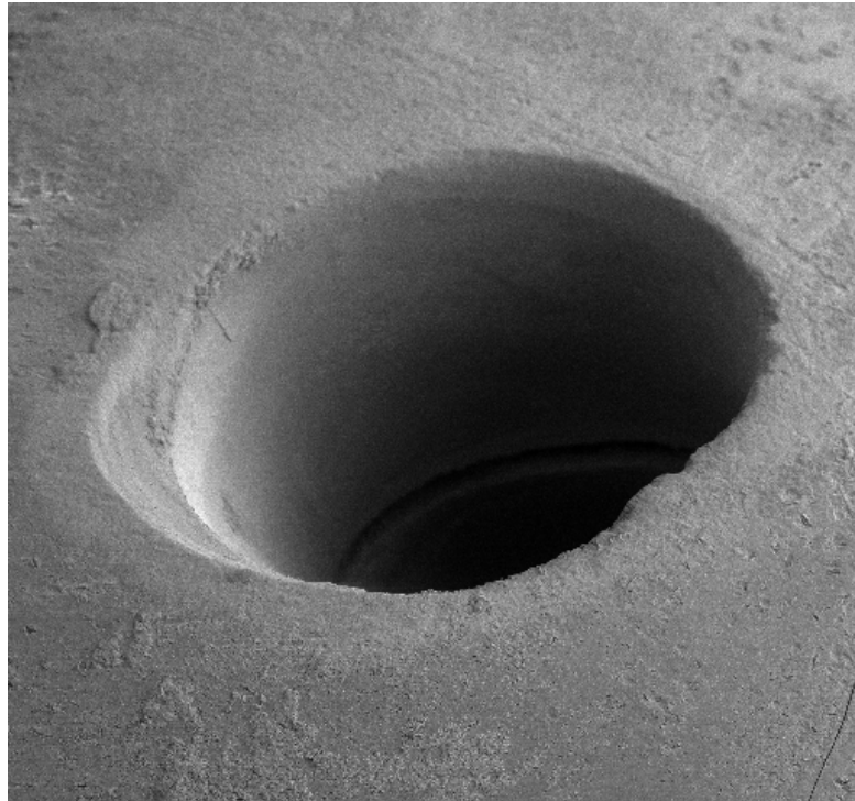
Figura 14 - Detalhe do preparo dos espécimes nas faces vestibular e lingual dos molares com 1mm de diâmetro e 3mm de altura com a ponta diamantada n.º 1012 e a broca carbide n.º 245
