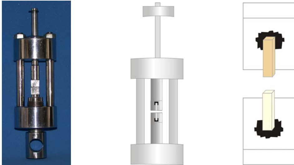
Figuras 10.1, 10.2 e 10.3 - Foto e esquema representativo do dispositivo de microtração Bencor Multi-T e dos espécimes sendo fixados ao dispositivo de microtração
