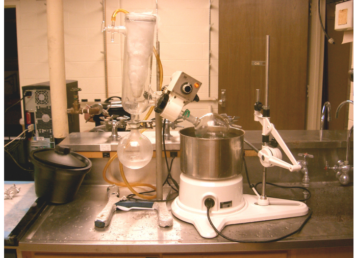
Figura 4.10 - Remoção de solvente com rotavapor.
