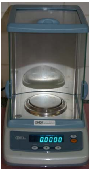
Figura 2 – Balança de precisão de quatro casas decimais
