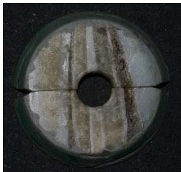
Figura 1 – Matriz de dente bovino com orifício central com dimensões de 3mm de espessura e 5mm de diâmetro
