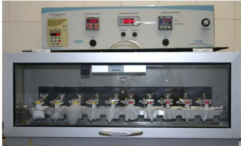
Figura 9 – Vista frontal da máquina de escovação, a qual possui em sua parte superior um painel de controle de dados e na inferior os dispositivos para colocação das escovas dentais e corpos-de-prova
