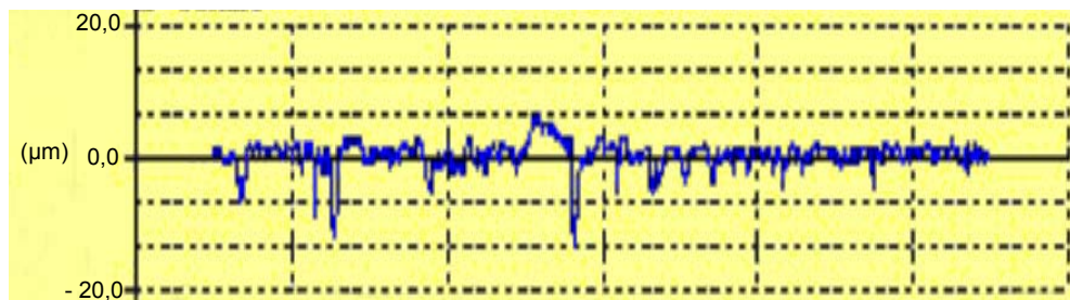
Figura 21 – Gráfico da rugosidade do rebolo de porcelana, após sua retificação.
