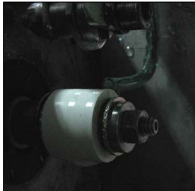
Figura 20 - Rebolo de porcelana com 2 sulcos de desgaste.
