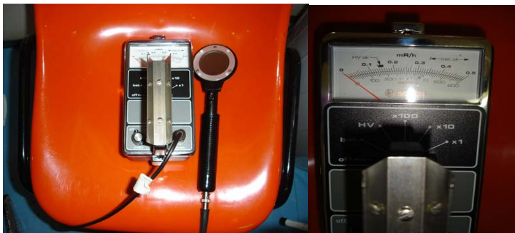
Figura 32. Contador-detector Geiger-Muller (BICRON), com sonda Pancake, utilizado no monitoramento.
