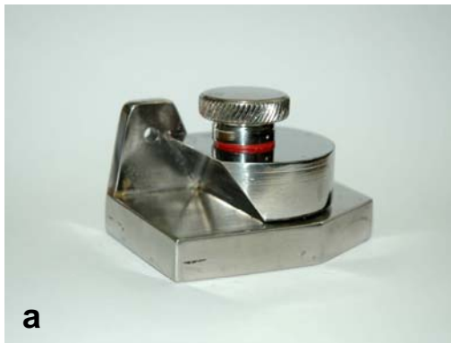
Figura 3 – (a) Dispositivo auxiliar de confecção do padrão. (b) Um padrão de cera/resina sendo confeccionado.
