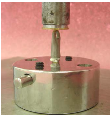
Figura 15 – Uma coroa, sendo cimentada com fosfato de zinco, sob a ponta ativa da prensa.
