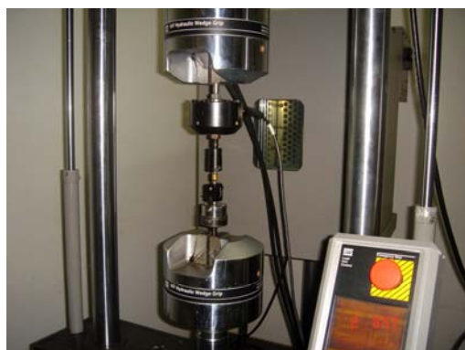
Figura 17 – Conjunto de acessórios usados para fixar um espécime na máquina.
