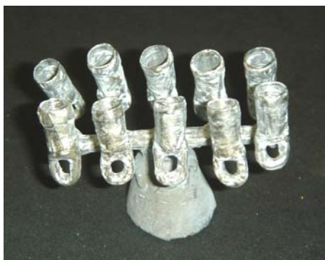
Figura 8 – Árvore com as 10 coroas, após a eliminação do revestimento.
