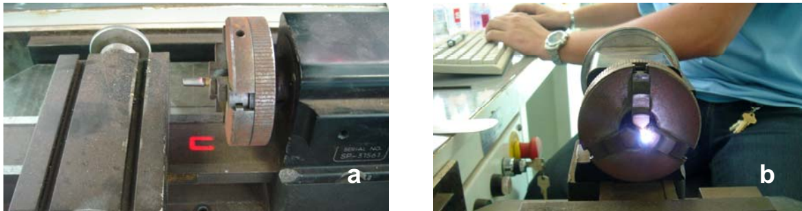
Figura 10 – (a) Munhão pronto para ser irradiado. (b) Munhão sendo irradiado pelo feixe de LASER.
