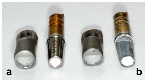
Figura 19 – Espécimes do grupo do fosfato, já ensaiados: (a) não-irradiado; (b) irradiado.
