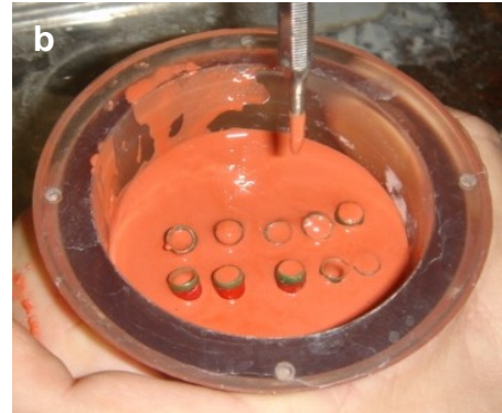
Figura 7 – (a) Uma árvore de padrões, dentro do anel de silicone. (b) Uma vista do conjunto de padrões, durante a operação de inclusão.
