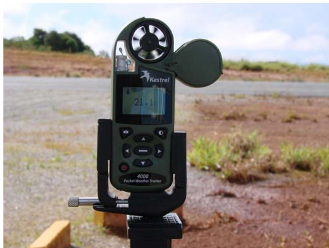
FIGURA 6 - Equipamento de bolso utilizado no monitoramento de velocidade do vento, umidade relativa e temperatura do ar
