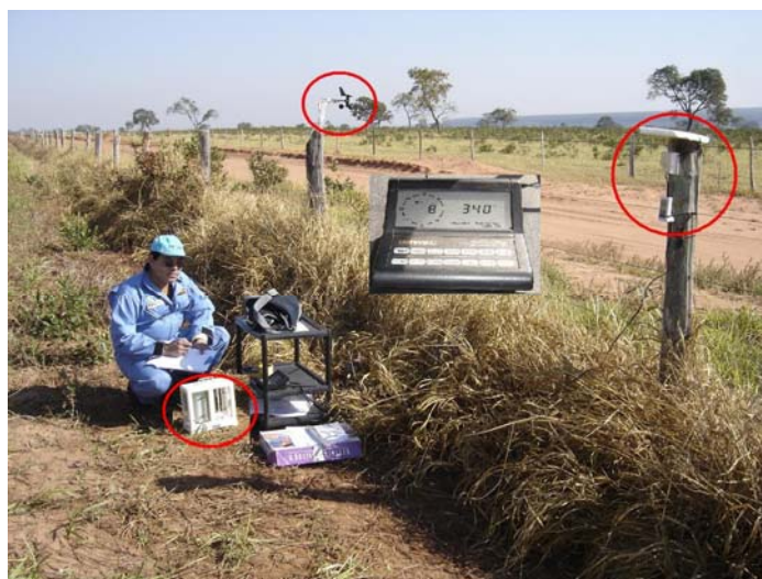
FIGURA 7 - Estação meteorológica portátil da marca Davis, modelo Weather, Monitor II e termo-higrógrafo
