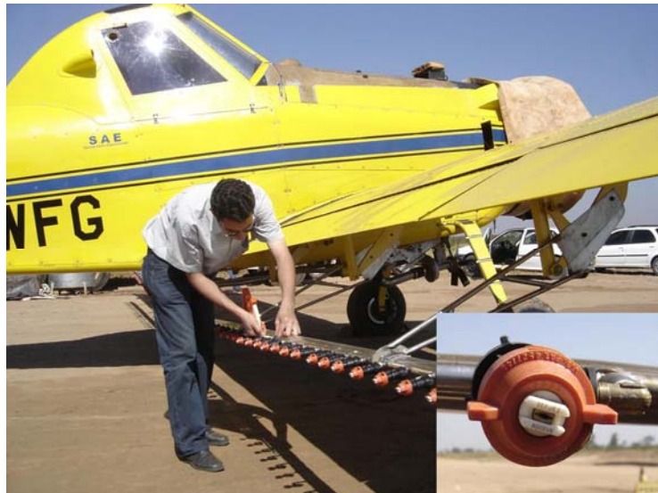
FIGURA 16 - Pontas de jato plano XR 8008 VB instaladas na barra de pulverização da aeronave Air Tractor AT-401B
