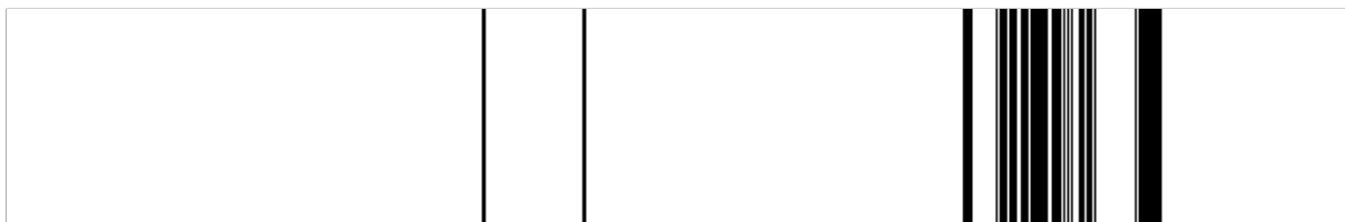
Figura 4.21: Resultado da erosão condicional utilizando a imagem de borda superior como marcador e a imagem erodida anteriormente como máscara.
