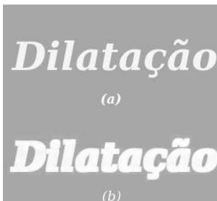
Figura 2.14: Dilatação em níveis de cinza com elemento estruturante quadrado planar e duas iterações: (a) Imagem original, (b) Imagem dilatada.
