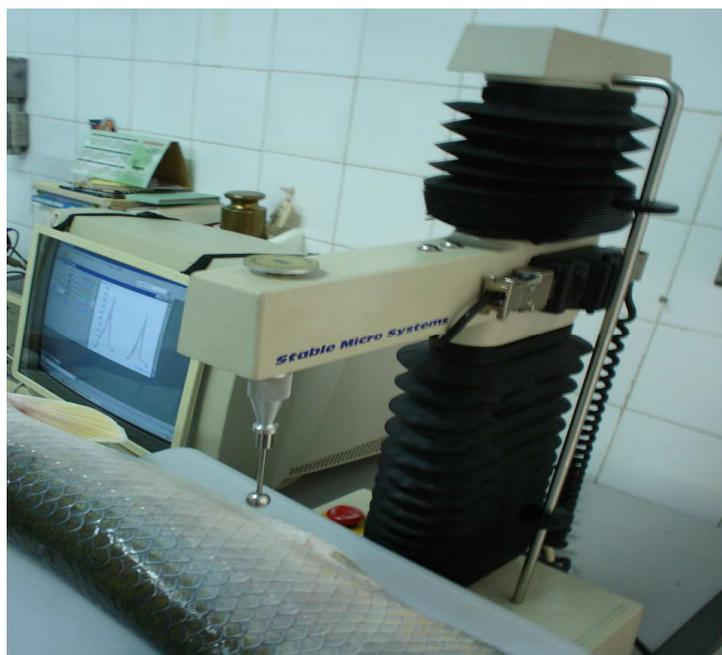
Figura 09 – Aparelho texturometro para Análise da textura.
