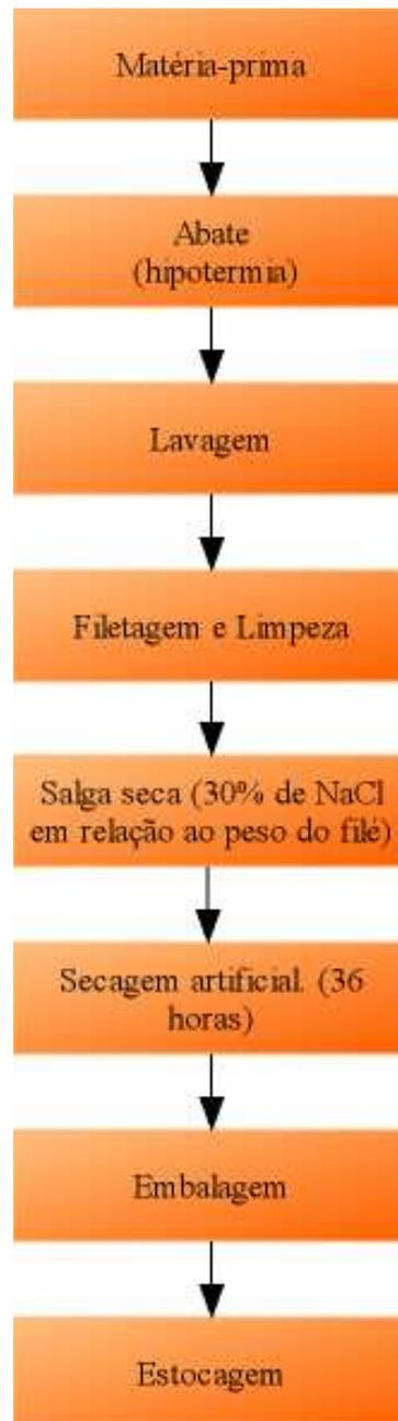
Figura 12 – Fluxograma do processamento de filé salgado e seco.
