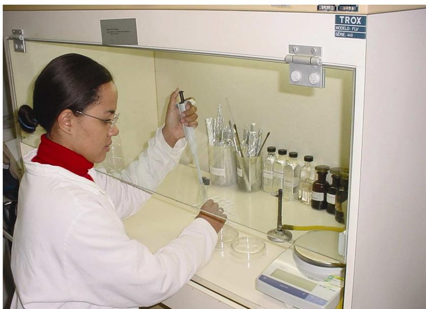
**Figura 7** - Inoculação das amostras em capela de fluxo laminar
