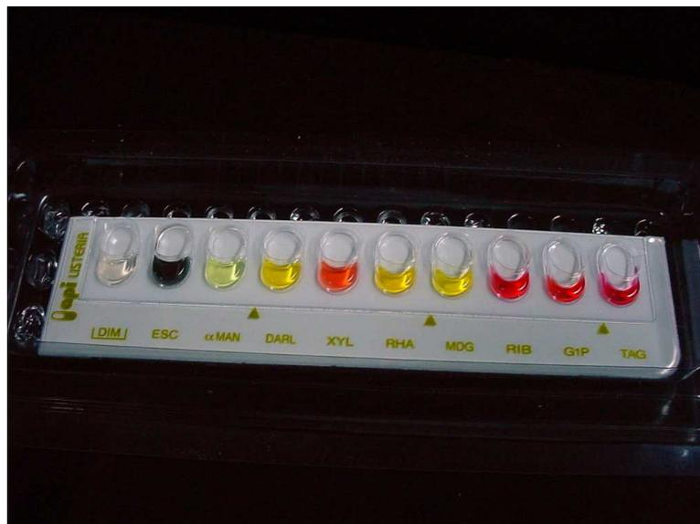
**Figura 9** - Bateria do Kit api<sup>®</sup> para teste bioquímico com combinação de resultados confirmativa para *Listeria monocytogenes*.
