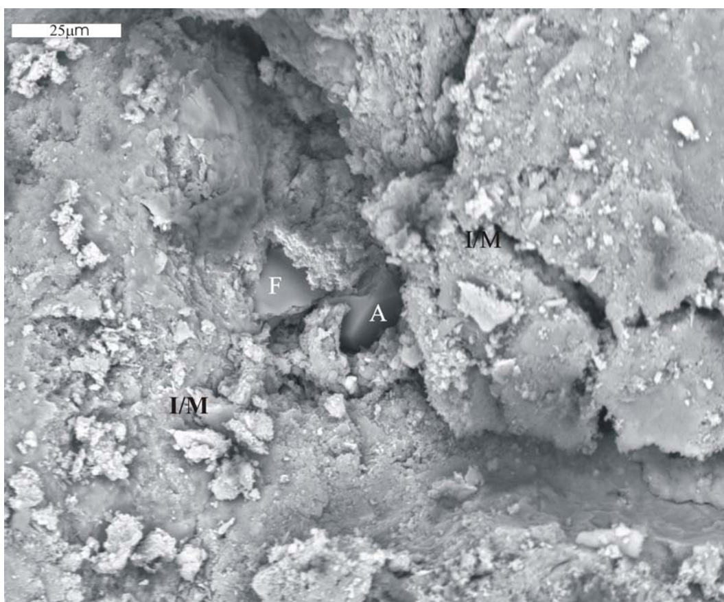
Figura 52: Ilita/montmorilonita (I/M) envolvendo grãos de analcima (A) e feldspato (F) (Fotomicrografia de MEV, em fragmento de rocha). Amostra (65/13) de testemunho de sondagem da Formação Santo Anastácio, poço de Pirapozinho (SP).
