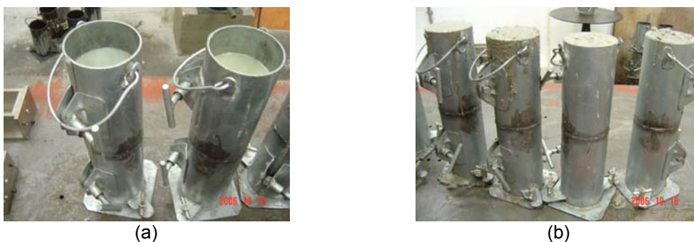
Figura 5.43 - (a) molde com acessório em tecnil antes da moldagem; (b) moldes com tecnil durante o adensamento em mesa vibratória.
