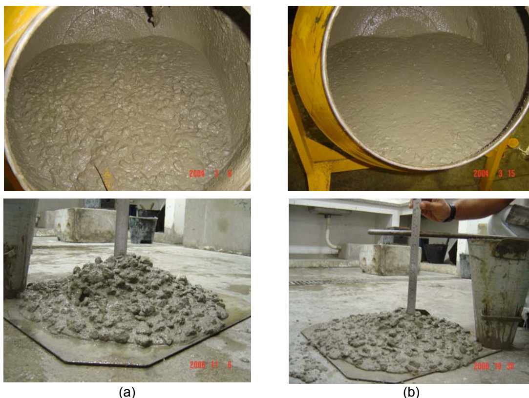
Figura 6.5 - (a) Concreto de referência, logo após o término da mistura: acima, aspecto do concreto na betoneira e abaixo, abatimento de 200 mm; (b) Concreto com 2% de ARR, logo após o término da mistura: acima, concreto na betoneira e abaixo, abatimento de 220 mm.
