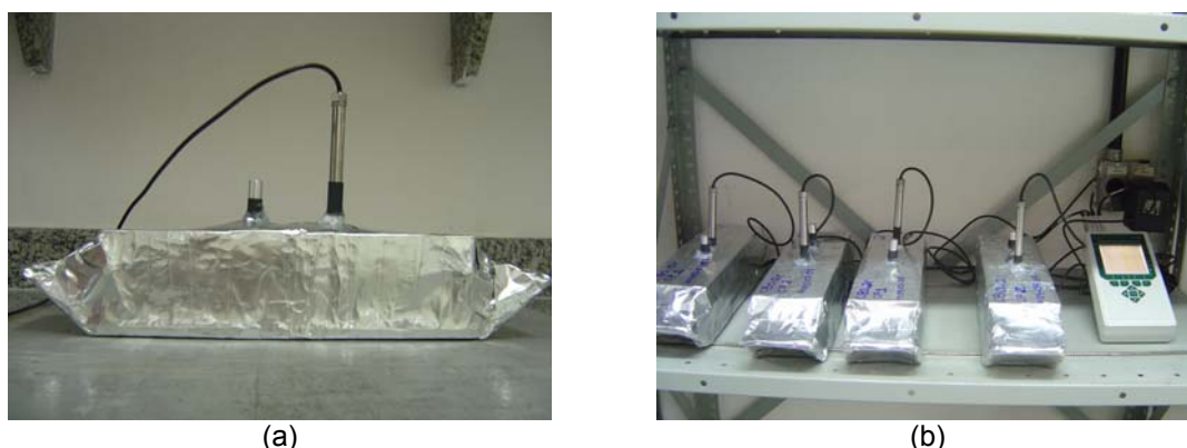
Figura 5.35 (a) Corpo-de-prova selado com filme plástico e fita adesiva de alumínio na sala com T = 21^{\circ}\text{C} e (b) Sistema de aquisição automática da redução da UR e da temperatura interna do concreto.
