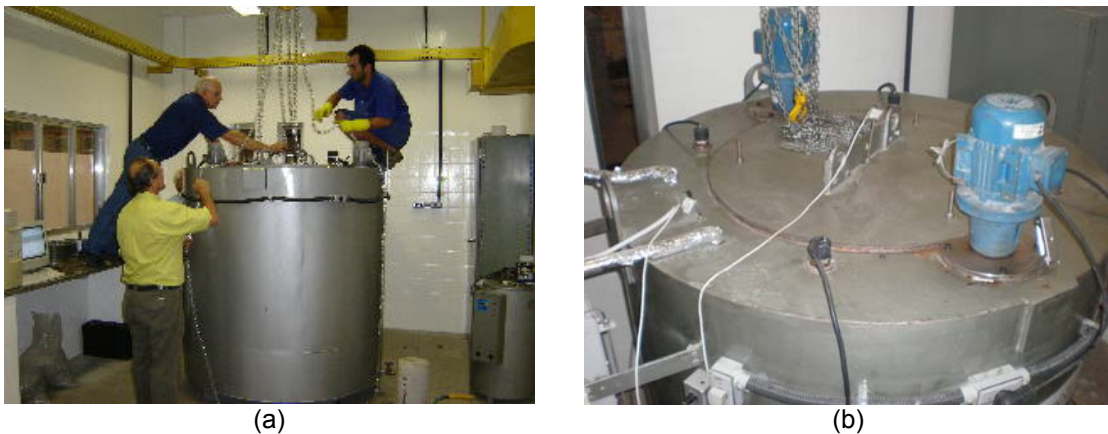
Figura 5.46 –Fechamento do calorímetro e colocação dos termômetros.
