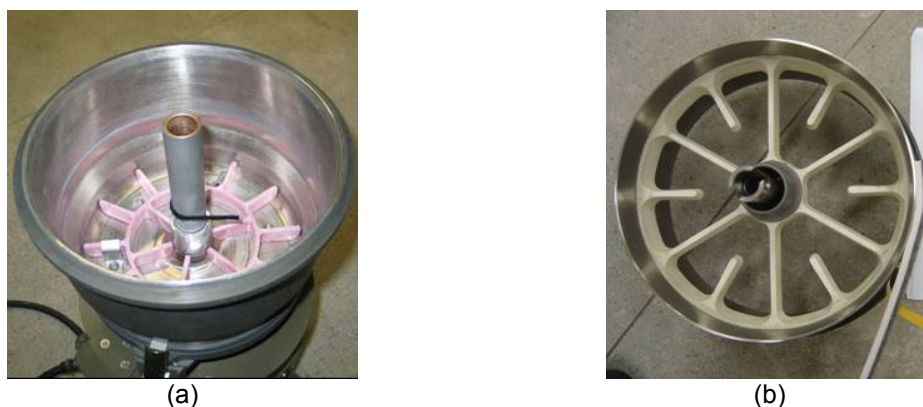
Figura 5.20 - Colocação de selos de vedação no BTRHEOM: (a) no recipiente fixo (selo interno) e (b) na parte móvel (selo externo).
