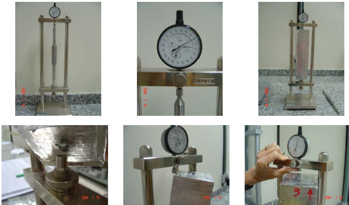
Figura 5.32 Procedimento para zerar o aparelho comparador e determinar a retração autógena, após a desforma.
