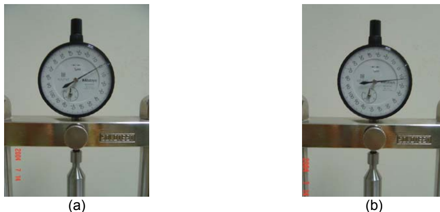
Figura 6.30 Calibração do aparelho comparador: (a) leitura feita no início de uma determinação e (b) leitura feita imediatamente após a anterior, conduzindo a resultados diferentes.
