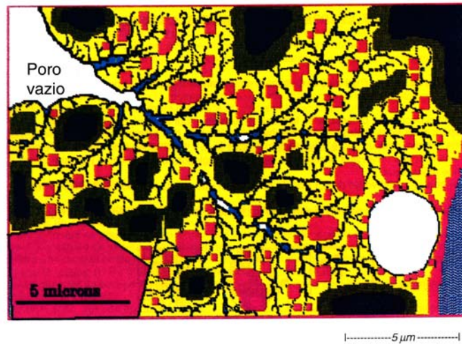
Figura 4.17 - t = 28 dias. A hidratação conduz à autodessecação. Os poros capilares se esvaziam pouco a pouco (segundo VERNET et al., 1992 apud BAROGHEL-BOUNY, 1994).
