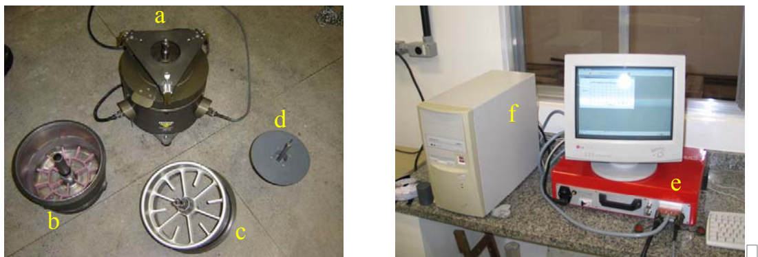
Figura 5.18 - BTRHEOM desenvolvido no LCPC - Laboratoire Central des Ponts et Chaussées, Paris (De LARRARD et al. 1994 apud De LARRARD, 1999): (a) corpo; (b) recipiente fixo para armazenamento do concreto com as pás inferiores no fundo; (c) parte móvel encaixada no eixo do recipiente fixo; (d) dispositivo medidor de dilatação; (e) unidade de controle e (f) microcomputador para aquisição dos dados.
