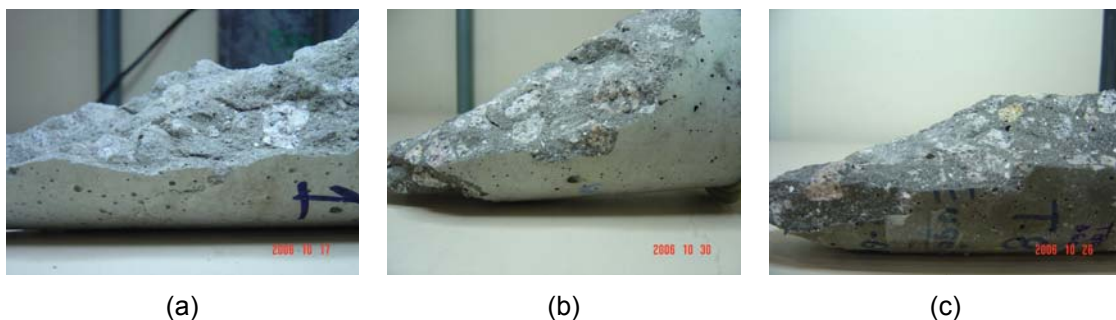
Figura 6.39 – Tipos de fratura: (a) áspera; (b) lisa e (c) transgranular.
