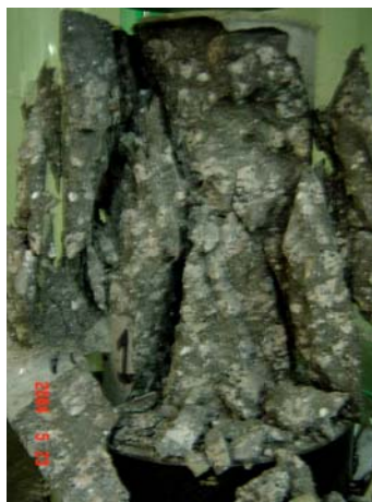
Figura 6.42 - Ruptura explosiva de corpo-de-prova de alta resistência C80.
