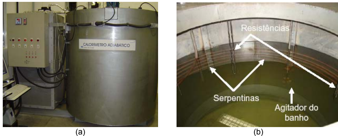
Figura 5.44 - Calorímetro adiabático da temperatura. (a) painel de controle de temperatura, à esquerda e tanque de banho, à direita; (b) interior do tanque de banho com água.
