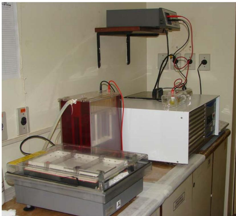
**Figura 15 Equipamento para 2D-E modelo Multiphor II (Amersham Bioscience®), a) cuba de focalização isoeétrica b) cuba de eletroforese c) banho de circulação d) fonte de alimentação elétrica.**
