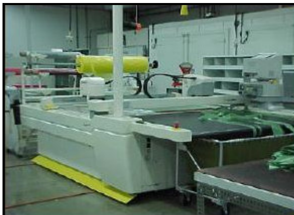
Figura 9: Recorte automático de tecido pré-impregnado (1999). (Fonte: YOKOTA, 2004)
