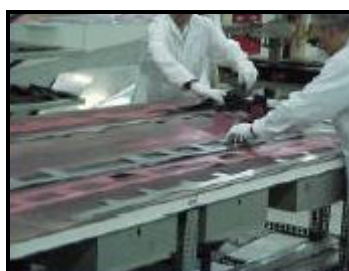
Figura 8: Recorte manual de tecido pré-impregnado (1998). (Fonte: YOKOTA, 2004).
