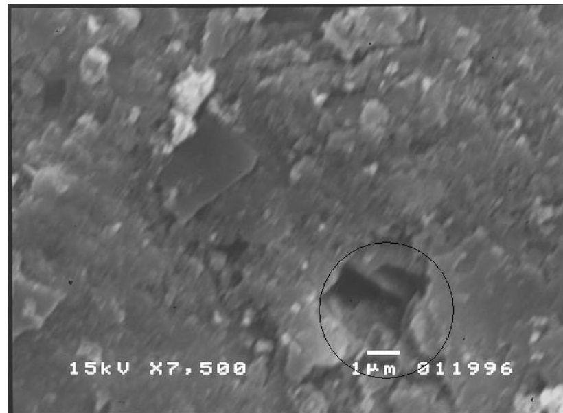
FIGURAS 41 e 42 - Fotomicrografia do substrato cerâmico, face externa (seção longitudinal), com detalhes dos poros. Imagem de elétrons secundários.
