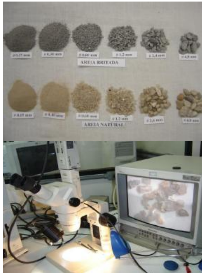
FIGURA 2 - Amostras das frações das areias e lupa com câmera digital acoplada (ARAÚJO; TRISTÃO, 2001).
