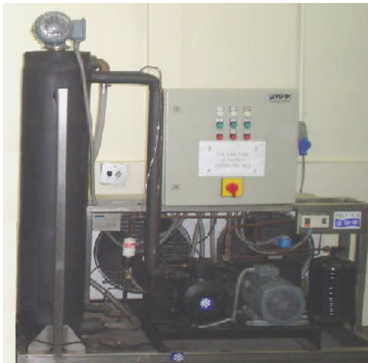
Figura 19 – Sistema de geração de Pasta de Gelo, da York.
