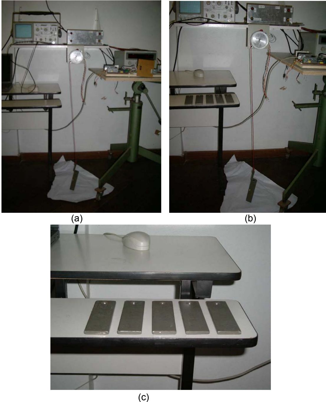
Figura 4.1: Fotografias (a) e (b) ilustrando a montagem do motor carregando uma massa antes do início de uma corrida. Em (c) são mostradas as massas utilizadas nos ensaios.
