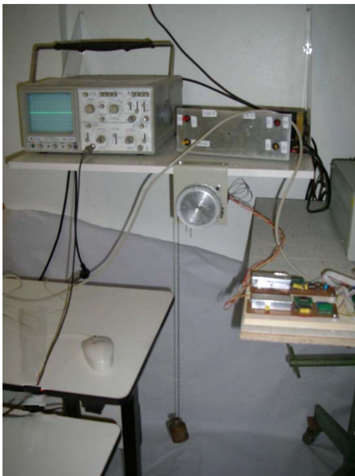
Figura 4.5: Fotografia ilustrando a montagem do motor carregando uma massa antes do início de uma corrida
