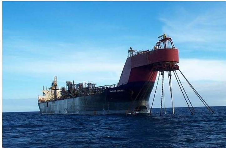
**Figura 8 – Vista Geral do navio com ancoragem tipo turret.**
