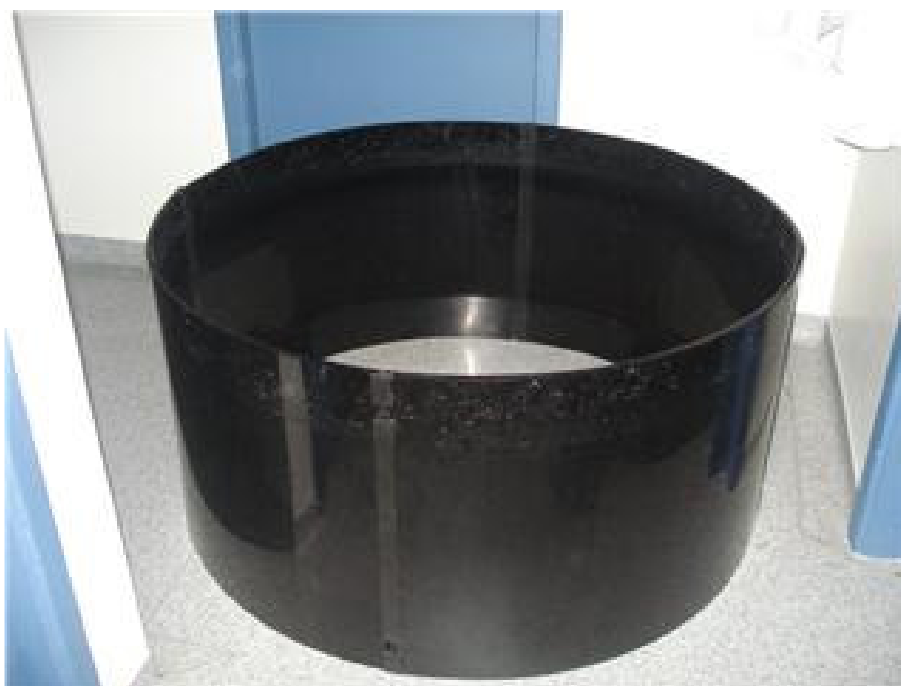
Figura 4. Cilindro utilizado para limitar o tamanho da piscina do LAM.
