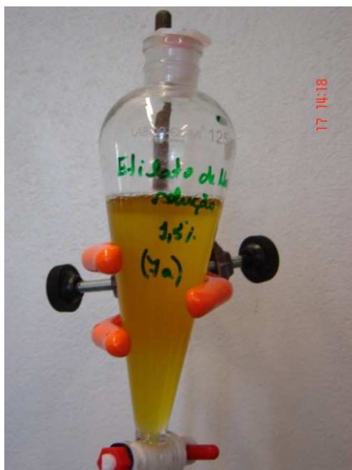
FIGURAS 7. Fotos dos experimentos realizados com 1,5% e 2% do catalisador etilato de sódio, razão molar álcool:sebo 6:1, temperatura de 55°C e tempo de 15 minutos.
