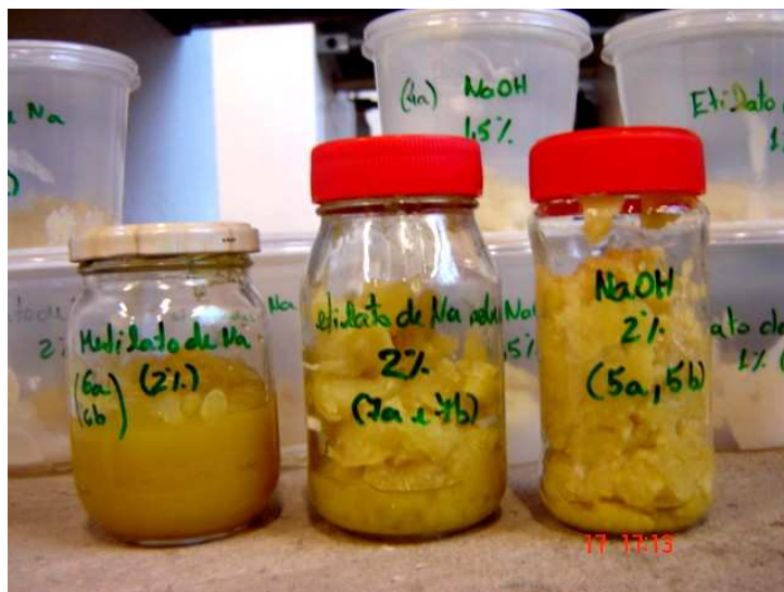
FIGURA 8. Foto dos experimentos realizados com 2% de etilato de sódio e NaOH, razão molar álcool:sebo 6:1, temperatura de 55°C e tempo de 15 minutos.
