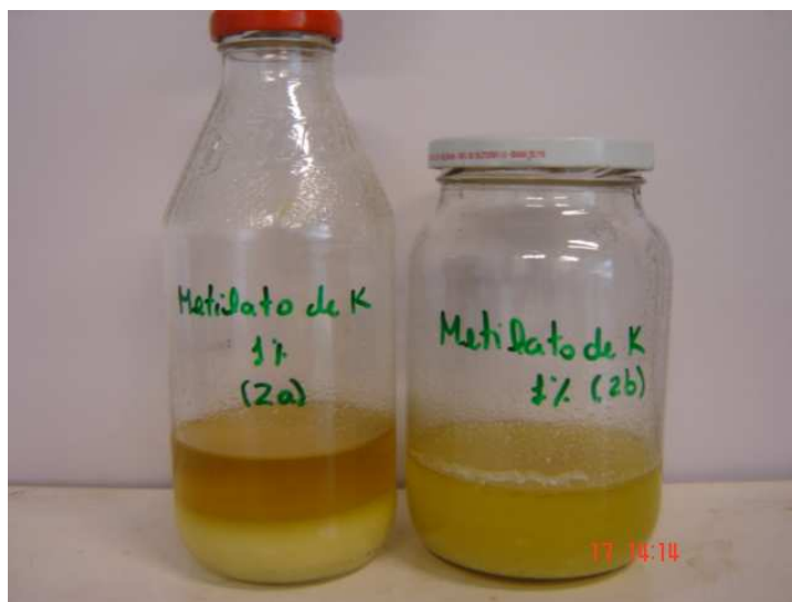
FIGURA 9. Fotos dos experimentos realizados com 1% do catalisador metilato de potássio, razão molar álcool:sebo 6:1, temperatura de 55°C e tempo de reação igual há 15 minutos.
