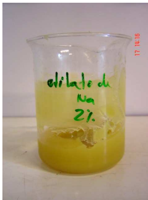
FIGURAS 7. Fotos dos experimentos realizados com 1,5% e 2% do catalisador etilato de sódio, razão molar álcool:sebo 6:1, temperatura de 55°C e tempo de 15 minutos.
