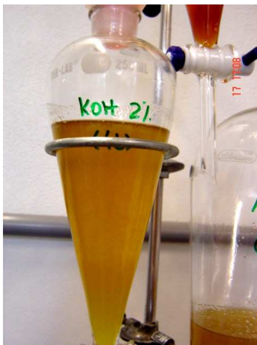
FIGURA 10. Foto do experimento realizado com 2% do catalisador KOH, razão molar álcool:sebo 6:1, temperatura de 55°C e tempo de 15 minutos.
