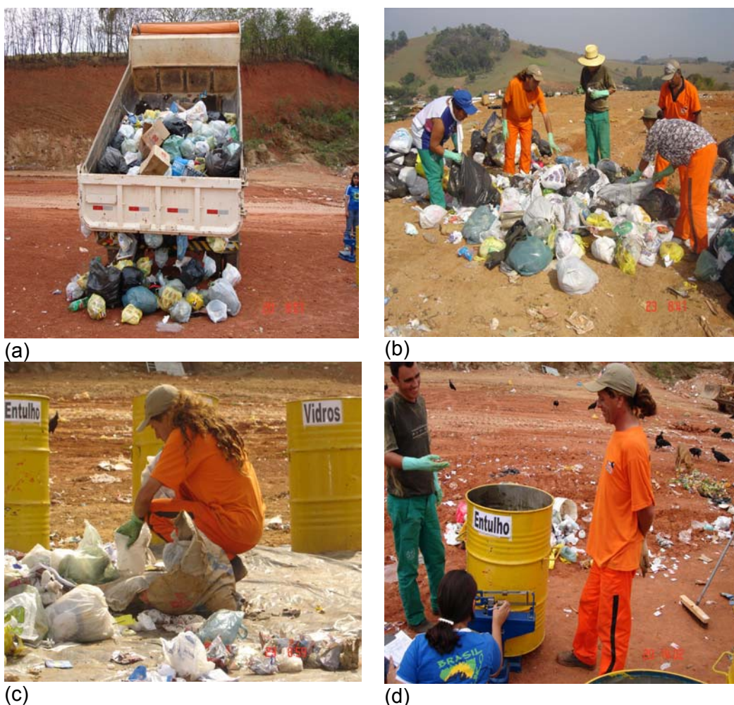
FIGURA 18 – Caracterização física dos resíduos sólidos domésticos e Comerciais: (a) Descarregamento dos resíduos coletados, (b) Quarteamento dos resíduos, (c) Triagem dos materiais, (d) Pesagem por tipo de resíduos
