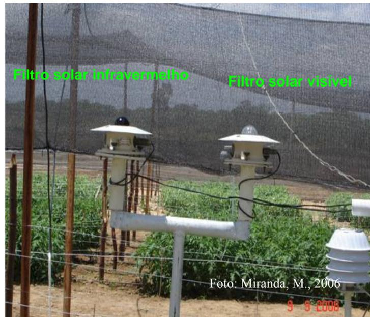
Figura 6 - Piranômetros espectrais Eppley
