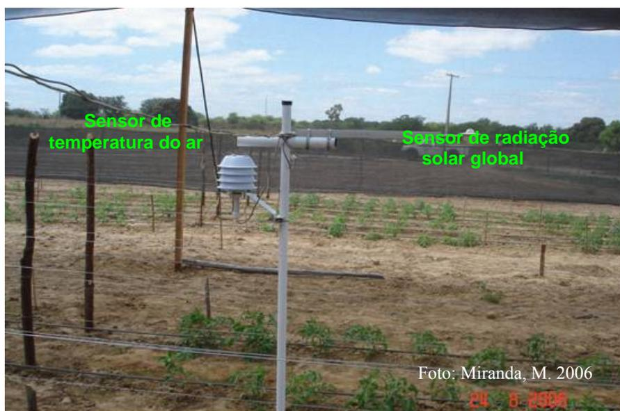
Figura 5 - Sensores de temperatura do ar e radiação solar global.
