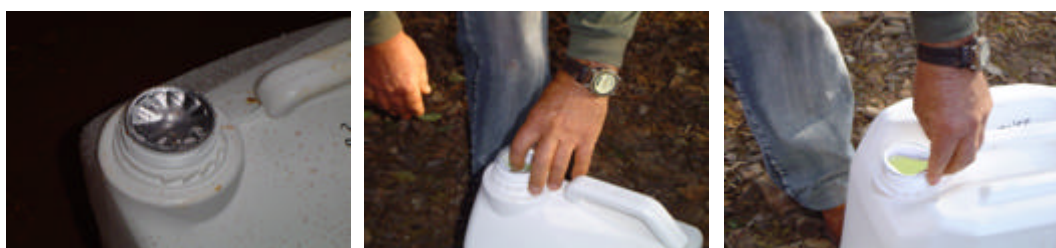
Figura 46 - Sistema para o rompimento do lacre
