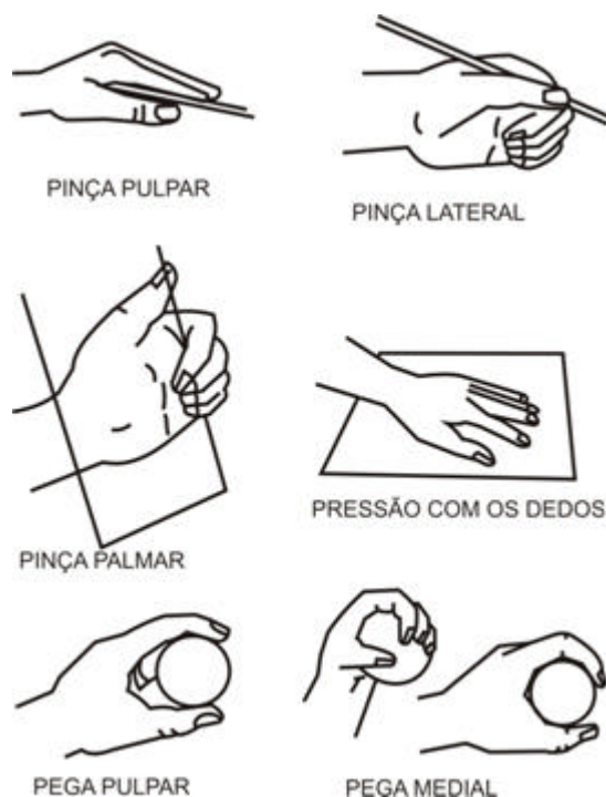
Figura 3 – Alguns tipos de pega Fonte: (PUTZ-ANDERSON, s.d. apud RIO; PIRES, 2001)
