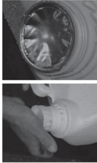
Figura 37 - Tentativas de rompimento do lacre
