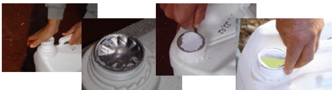
Figura 60 - Tentativas de rompimento do lacre
