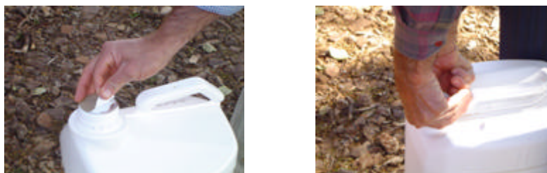
Figura 47 - Rebarba da costura da embalagem Retangular e espaço entre tampa e alça da embalagem Mauser
