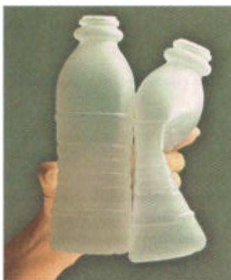
Figura 27 – Diferença entre uma garrafa em PEAD (esquerda) e em PEBD (direita) Fonte: (CANTO, 2004)
